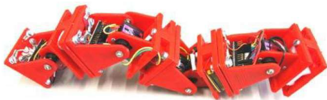
Figura 4. Robot ápodo funcional impreso en 3D
