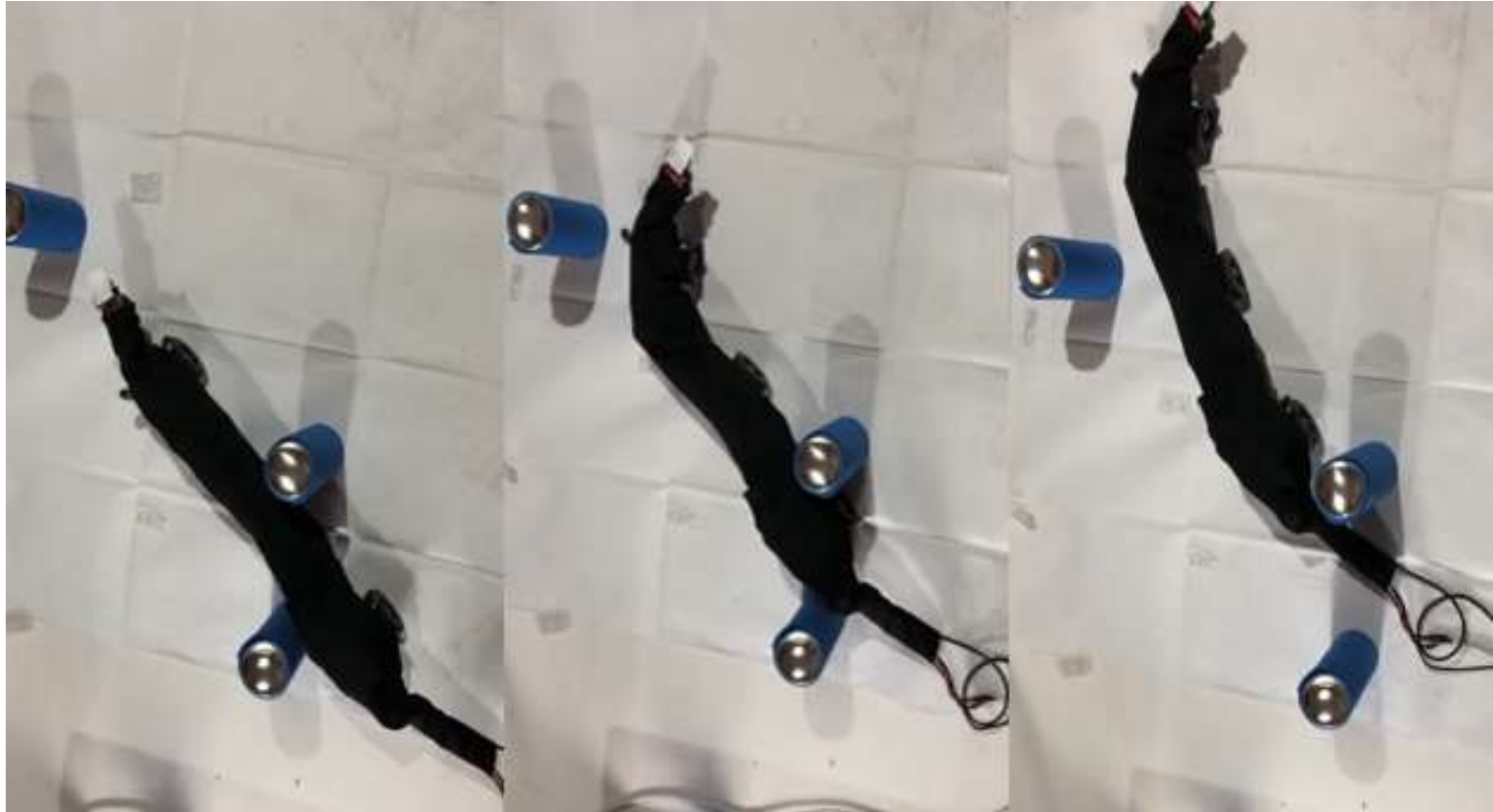
Prueba 3 de locomoción – restricción lateral
