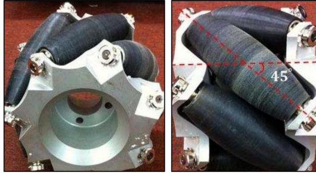
Figura 16. Rueda Mecanum resistente montada en AuckBot Fuente: (Xie, Scheifele, Xu, & Stol, 2015)
