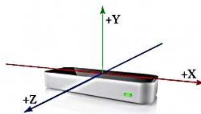
Figura 2. Sistema de coordenadas Leap Motion
