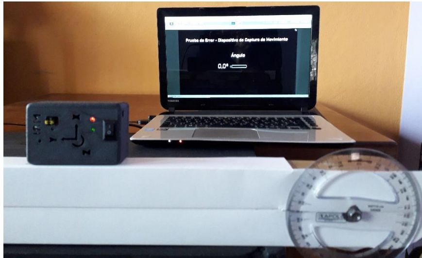
Figura 124. Prueba para Dispositivos de Detección de Movimiento
