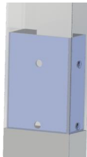
Figura 33. Disposición de Pernos Parte Trasera de la Columna
