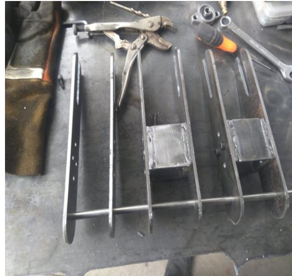
Figura 40 Armado de la porta lijas
