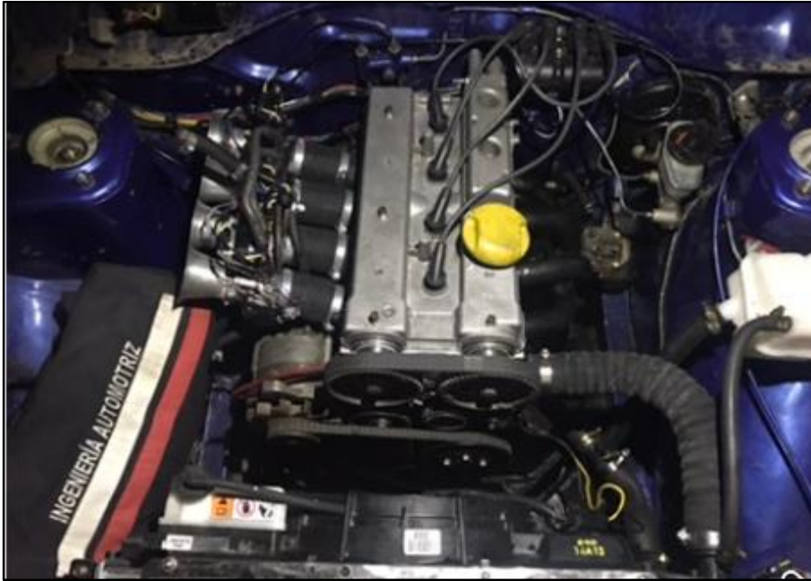
Figura 7. Motor Twin Cam Nissan A12
