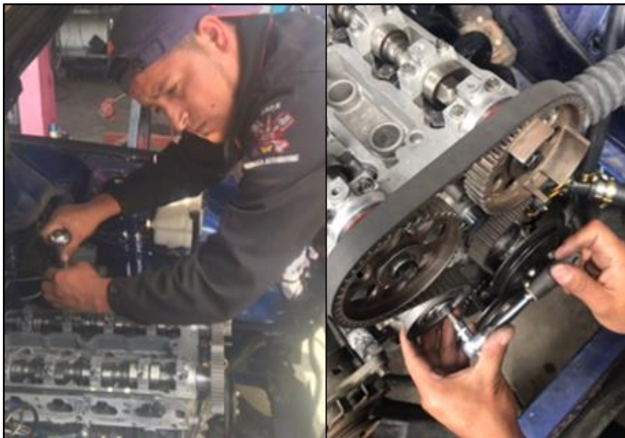
Figura 63. Armado sistema de distribución
