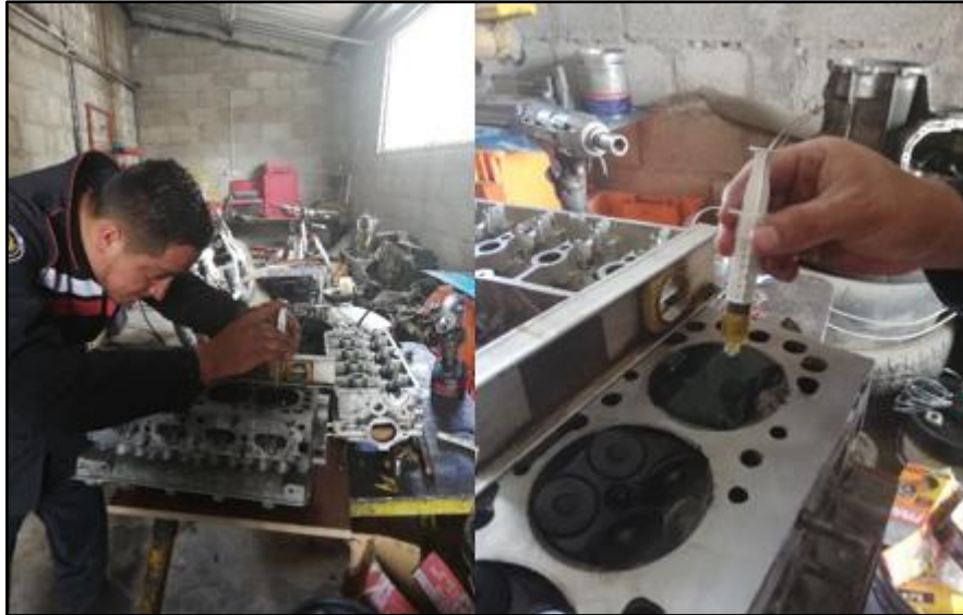
Figura 58. Pruebas de relación de compresión
