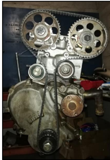
Figura 9. Sistema de distribución de doble árbol de levas
