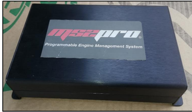
Figura 33. Computadora reprogramable MegaSquirt-II
