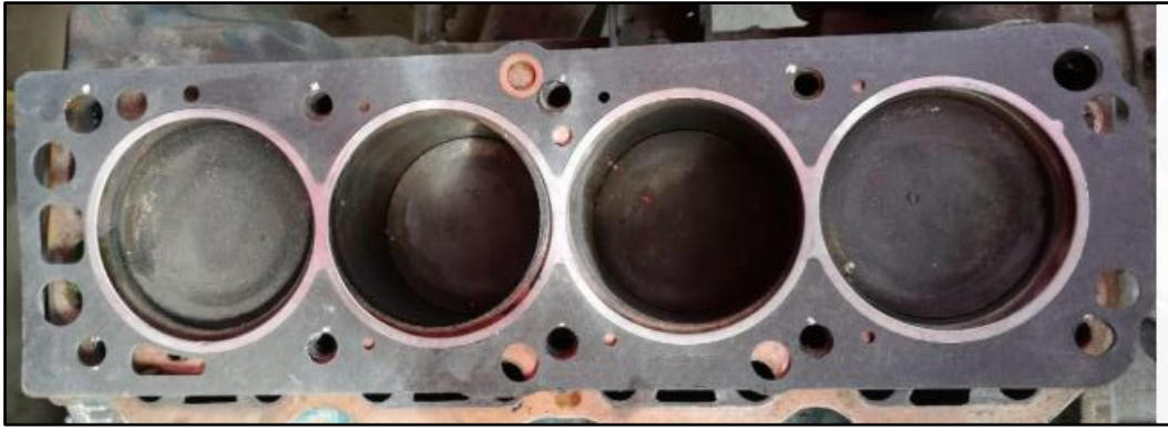
Figura 54. Geometría de empaques
