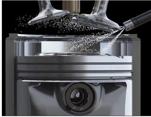
Figura 29. Entrega de combustible por el inyector Fuente: (ACTUALIDAD MOTOR, 2013)
