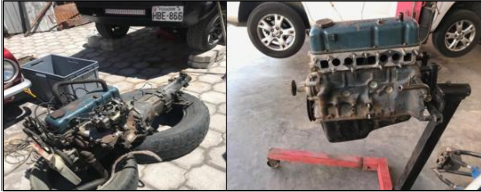
Figura 52. Desmontaje del motor
