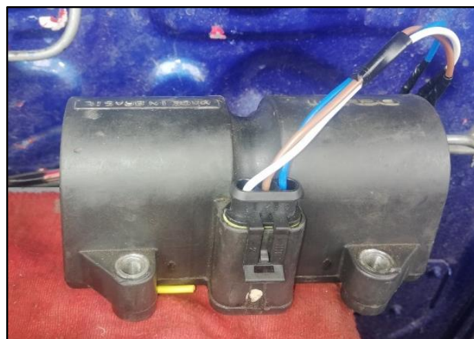
Figura 30. Bobina de encendido DIS.
