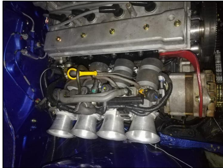
Figura 64. Cuerpo de aceleración.
