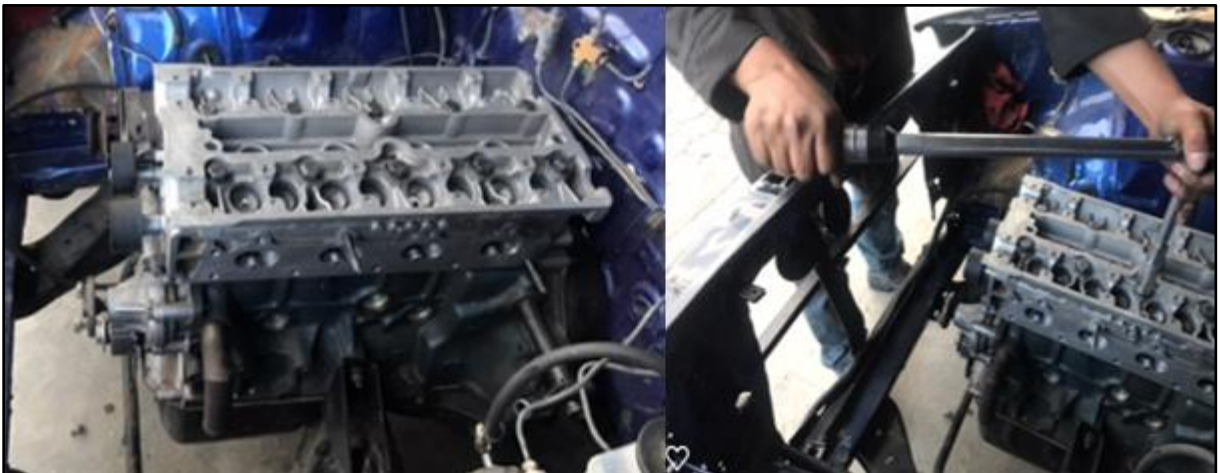
Figura 61. Torque de los pernos
