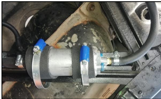
Figura 32. Bomba eléctrica de combustible
