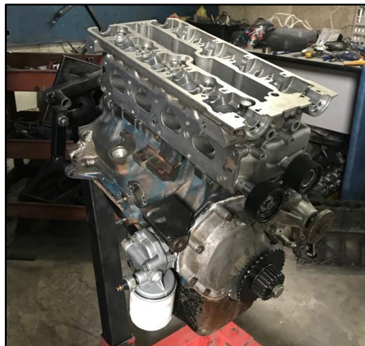
Figura 57. Cabezote adaptado al block
