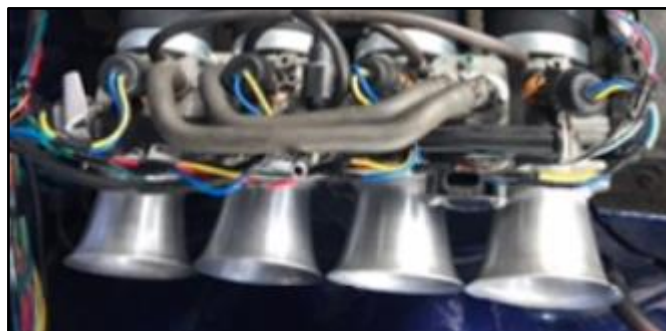
Figura 17. Cuerpo de aceleración ITB
