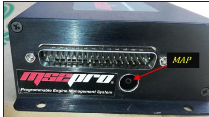
Figura 20. Sensor MAP incorporado
