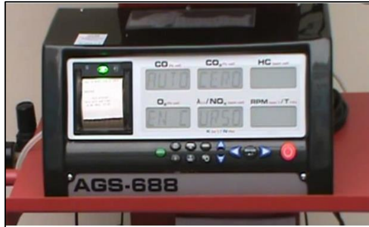
Figura 46. Analizador Brain Bee AGS-688
