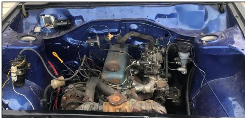
Figura 51. Datsun A12 carburador
