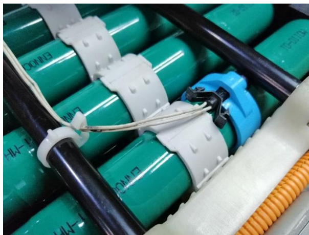
Figura 25. Sensores de temperatura con su base para las baterías con módulos cilíndricos.
