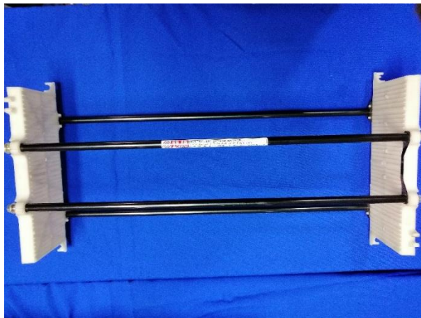
Figura 17. Base de la batería original del vehículo híbrido Toyota Prius
