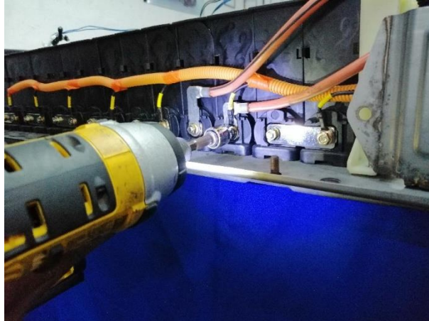
Figura 23. Conexiones del jumper o conector de servicio para la batería de módulos cilíndricos
