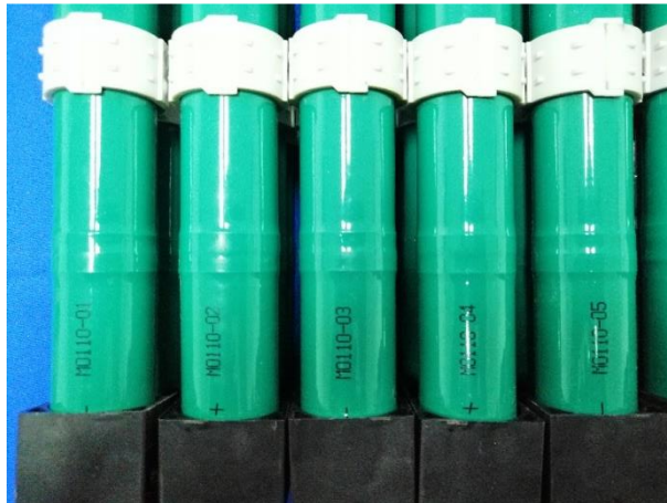
Figura 18. Orden de las celdas cilíndricas para poder colocar en la base original del vehículo híbrido
