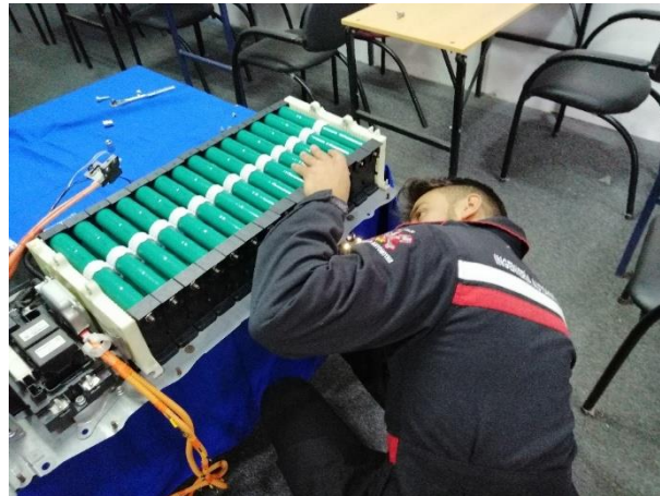
Figura 20. Fijación de los módulos cilíndricos en la base de la batería original del Toyota Prius
