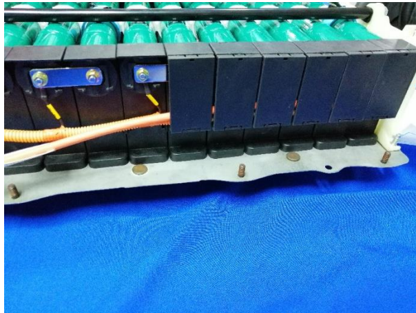
Figura 26. Cubierta de protección para la conexión de los ramales positivos y negativos en la batería de módulos cilíndricos.
