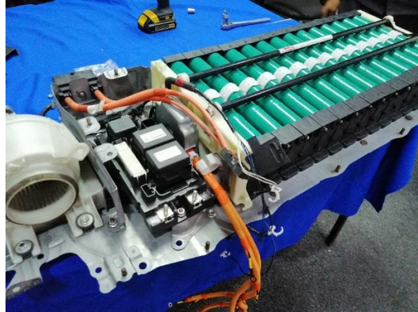
Figura 21. Conexión de los ramales positivo y negativo con el módulo híbrido
