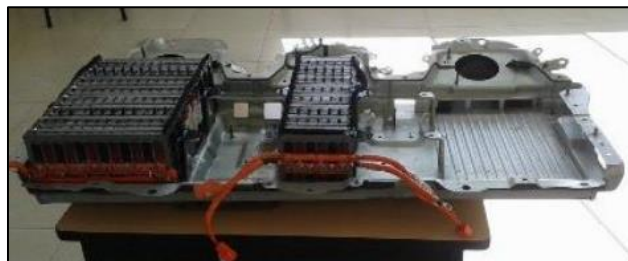
Figura 6. Pack de baterías.
