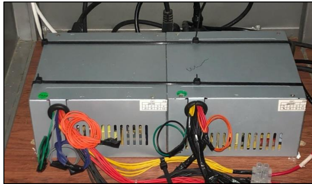
Figura 20. Fuentes de computador de 700 Watts conectadas en paralelo
