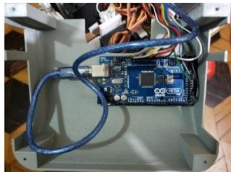
*Figura 105.* Ubicación de la placa Arduino MEGA.
