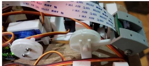
*Figura 103.* Ubicación de la cámara Raspicam con su sistema de poleas.
