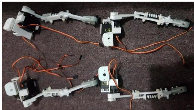
*Figura 98.* Ensamble de los 4 legs y su disposición
