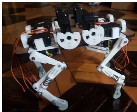
*Figura 101.* Ensamble final de los legs al robot.
