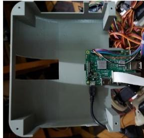
*Figura 104.* Ubicación del controlador Raspberry pi 3 B.
