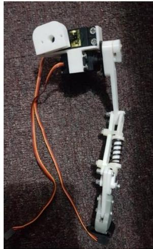
*Figura 97.* Ensamble de un leg.
