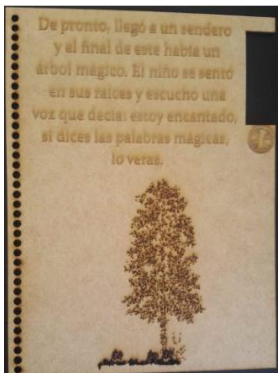
Figura 38. Primera hoja cortada y grabada con láser
