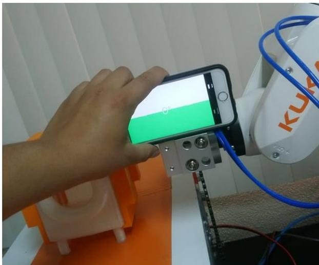
**Figura 86.** Medición de posicionamiento correcto de la lavadora sobre la banda
