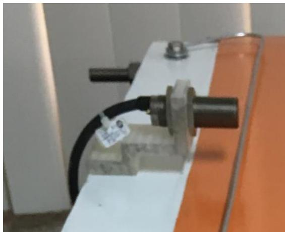
*Figura 66.* Sensor capacitivo en el soporte
