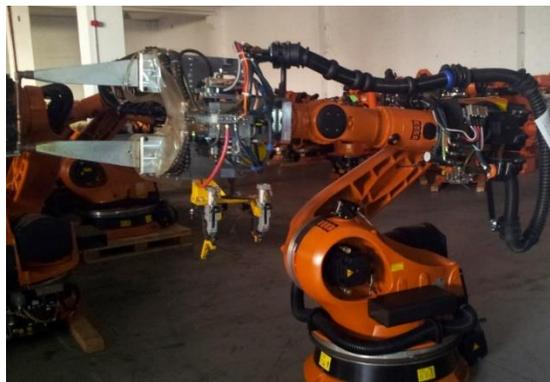
**Figura 14.** Robot de soldadura por puntos
