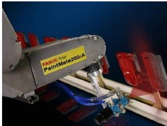
**Figura 16.** Proceso de pintado con Robots
