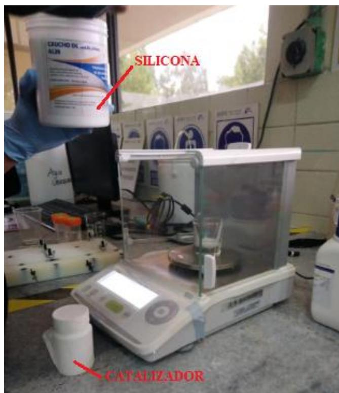
**Figura 29.** Preparación de la mezcla del material
