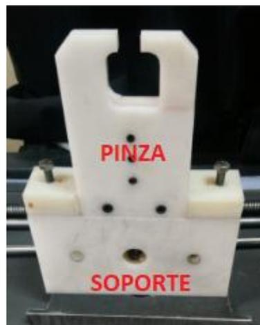
**Figura 23.** Unión soporte – pinza
