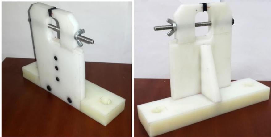
*Figura 10.* Pinza de Grilon, Vista Delantera / Vista Posterior
