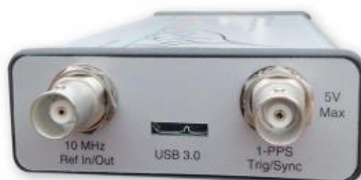
Figura 20 Parte posterior del BB60C. Fuente: (Signal Hound, Inc., 2019)
