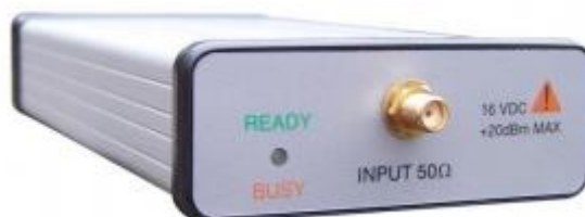
Figura 19 Vista frontal del BB60C. Fuente: (Signal Hound, Inc., 2019)
