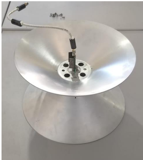
Figura 13 Extracción del cable de la antena Discone
