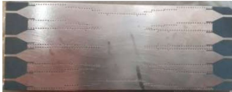
Figura 33 Placa del Acoplador Direccional de 4x4 puertos en sustrato RT Duroid 5880.
