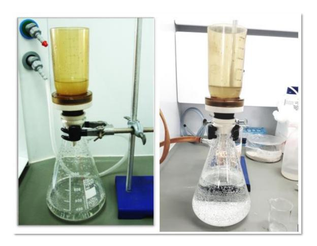
Figura 28. Equipo de filtración
