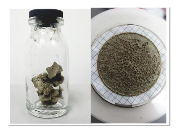
Figura 33. Producto del proceso de exfoliación de Vermiculita
