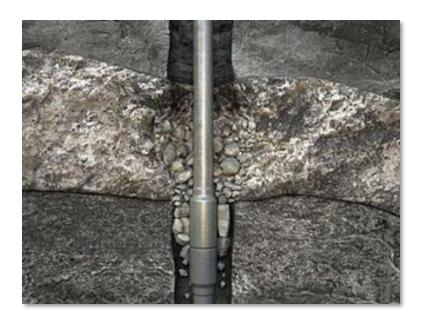
**Figura 4.** Derrumbamiento de pared en perforación Fuente: (Portal del petróleo, 2016)
