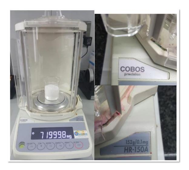
Figura 29. Balanza analítica electrónica
