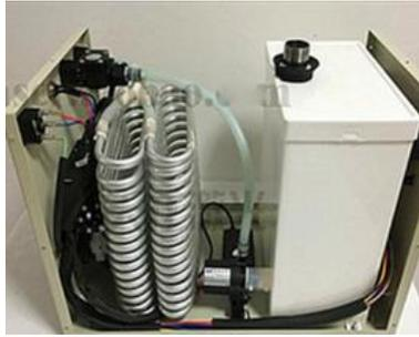
*Figura 95.* Reservorio de Agua del sistema de refrigeración
