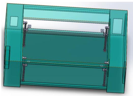
**Figura 93.** Sistema de levantamiento de cama
