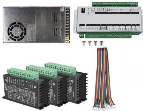
*Figura 7.* Controladores y placa de control de servomotores
