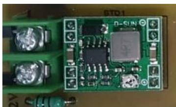
**Figura 99.** Implementación del Step Down en el circuito impreso
