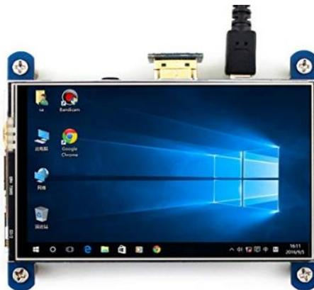
**Figura 17.** Pantalla táctil Raspberry Pi
