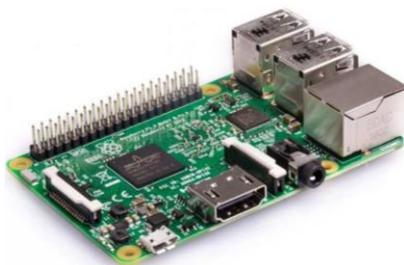
**Figura 15.** Raspberry pi 3 modelo B
