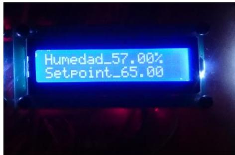
**Figura 76.** Datos en la LCD del sistema de Humedad
