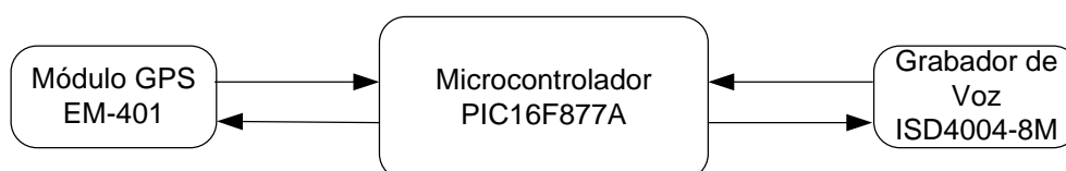
Figura. 3.1. Diagrama de Bloques General del Hardware
