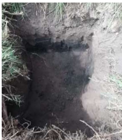
Figura 17. Calicata terminada para extracción de muestras
