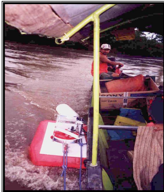
Foto 3.8. Aforo utilizando el ADCP (Acoustic Doppler Current Profiler Proyecto HiBam 2002)
