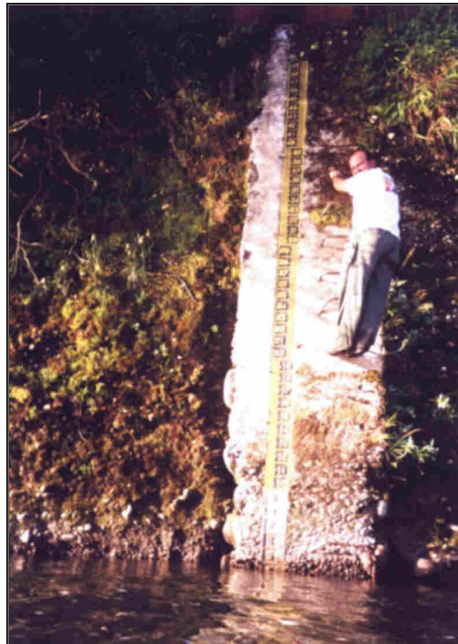
Foto 2.5. Río Jatunyacu, reglas limnimétricas. Estación D.J.Ilocullín
