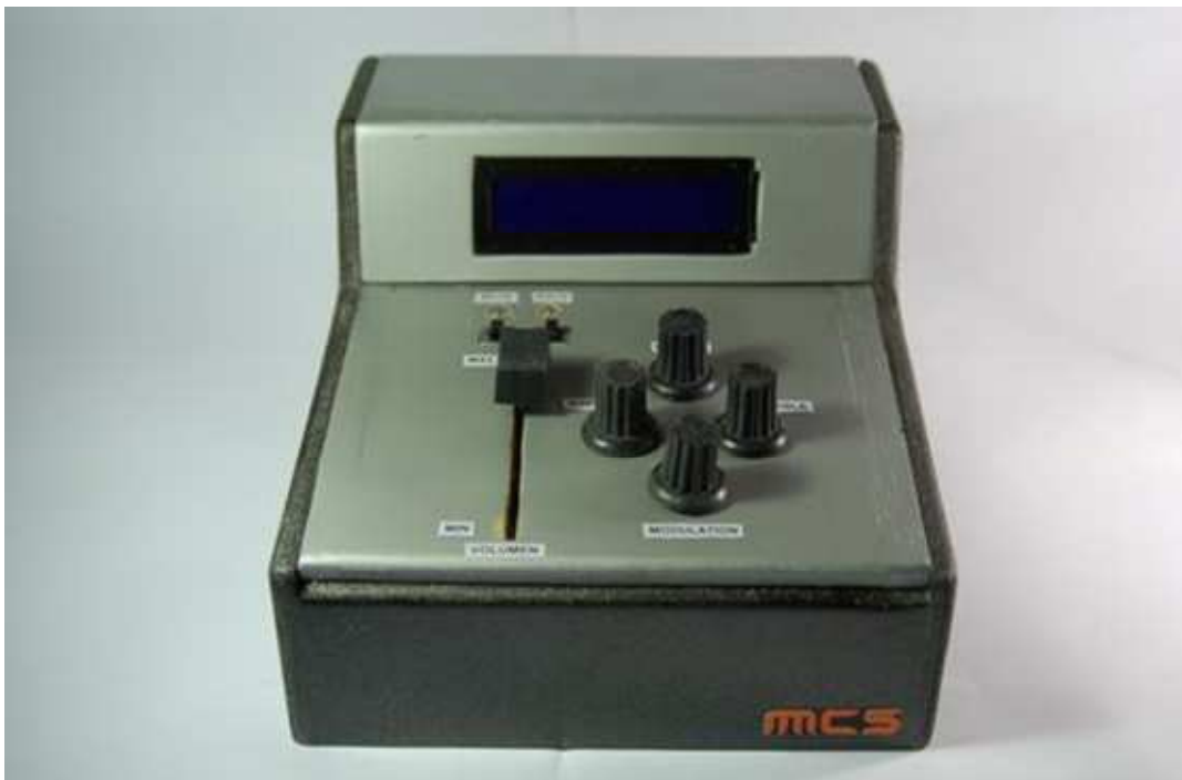
Figura 4.1. MIDI Control Surface diseñada.
