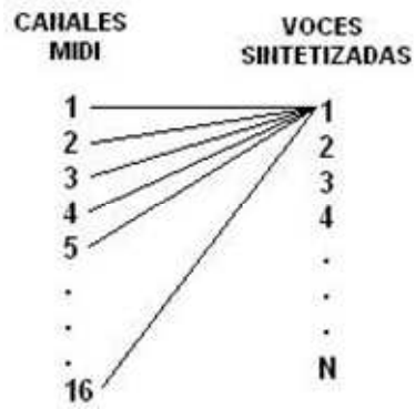
Figura 2.3. Ejemplo de asignación Voz/Canal en Modo 2 - Omni on/Mono.
