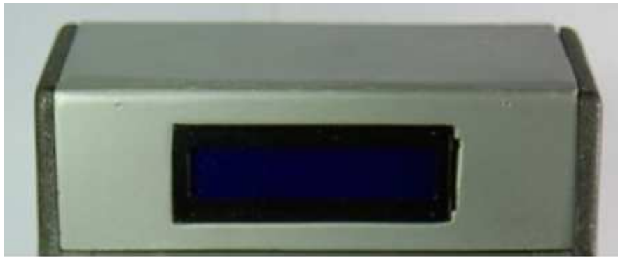
Figura 4.6. Display de cristal líquido usado para el diseño de la MCS.
