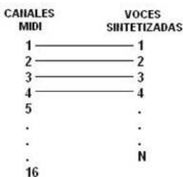
Figura 2.5. Ejemplo de asignación Voz/Canal en Modo 4 - Omni off/Mono.
