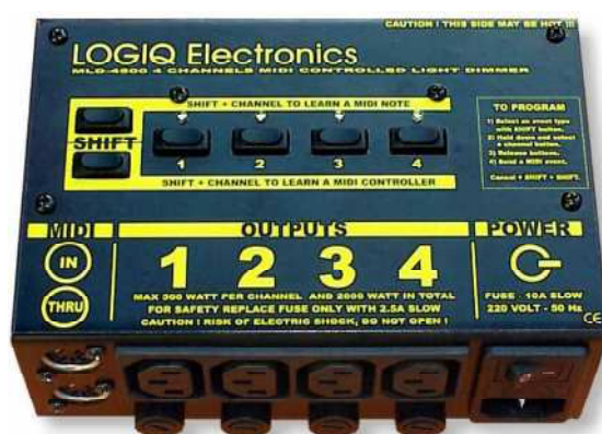
Figura 3.4. Superficie de Iluminación marca Logiq Electronics modelo MLD-4500, con 4 salidas controladas por MIDI.
