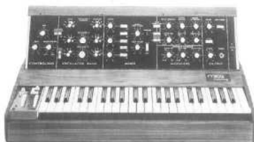
Figura 3. El MiniMoog, el primer sintetizador analógico controlado por tensión.
