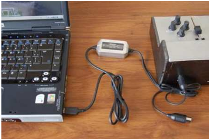
Figura 6.5. Conexión con cable adaptador MIDI/USB.
