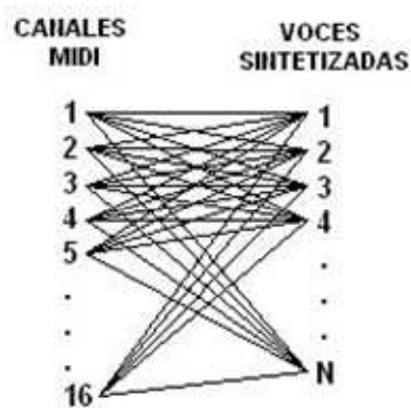
Figura 2.2. Ejemplo de asignación Voz/Canal en Modo 1 - Omni on/Poly.
