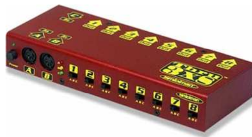
Figura 2.12. MIDI Thru Box de 3 entradas y 8 salidas marca M-Audio modelo Thru 3x8.
