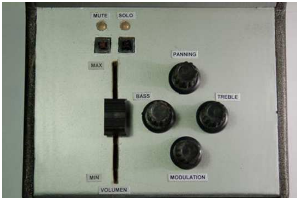
Figura 4.3. Bloque de controladores de la MCS diseñada.
