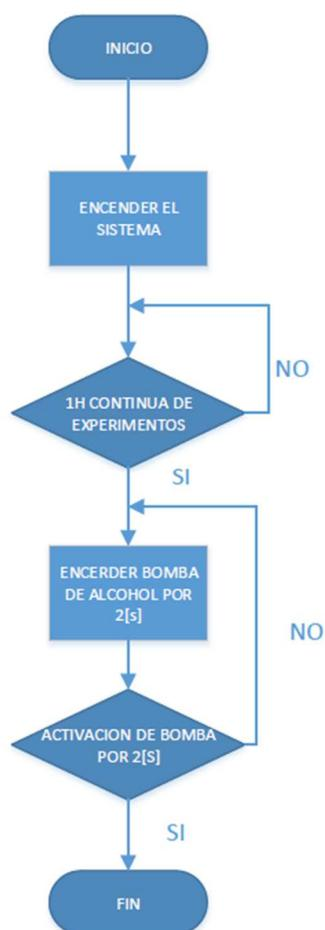
**Figura 61.** Diagrama de flujo del proceso de dopaje automático
