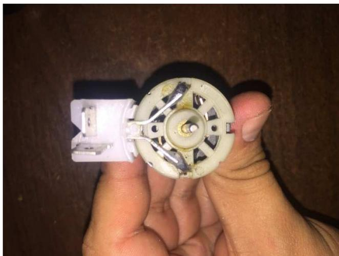
**Figura 57.** Oxidación de la bomba
