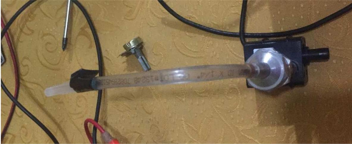
**Figura 59.** Colocación de una aguja a la salida del flujo de alcohol.
