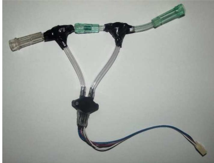
**Figura 15.** Neumotacógrafo con resistencia mecánica
