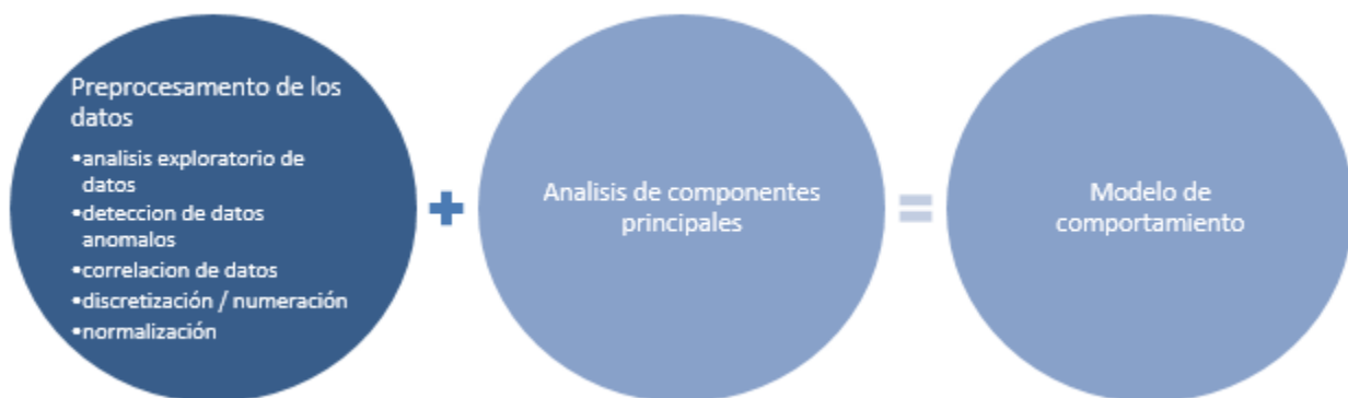
Figura 5. Pre-procesamiento de datos. Fuente: Ilustración propia
