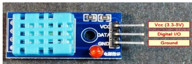
Figura 46. Módulo DHT11
