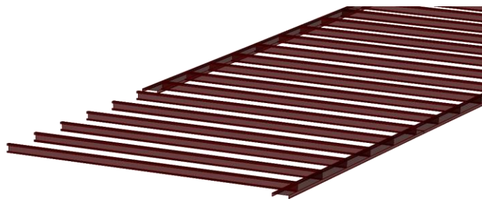
Figura 13. Detalle de viguetas de entrepiso
