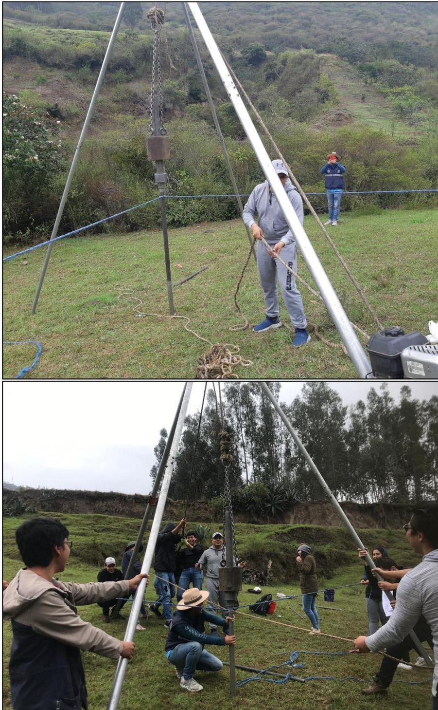
**Figura 44.** Ensayo de SPT
