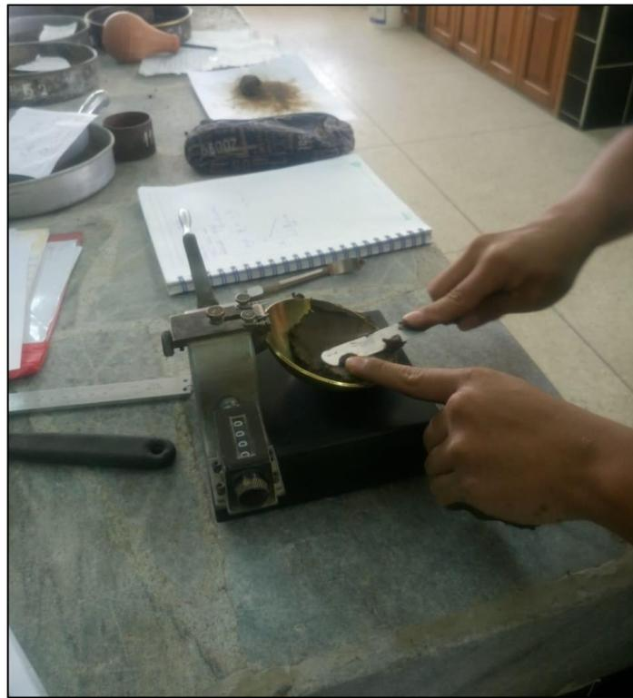
**Figura 21.** Ensayo de Limites de Consistencia
