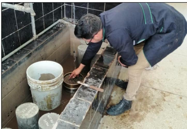
**Figura 23.** Lavado de la muestra para ensayo de Granulometría
