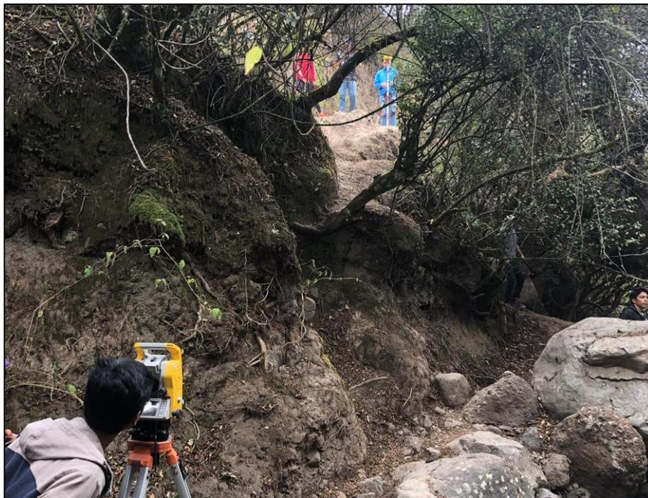
**Figura 11.** Enlace de puntos del RTK con los de la Estación Total.
