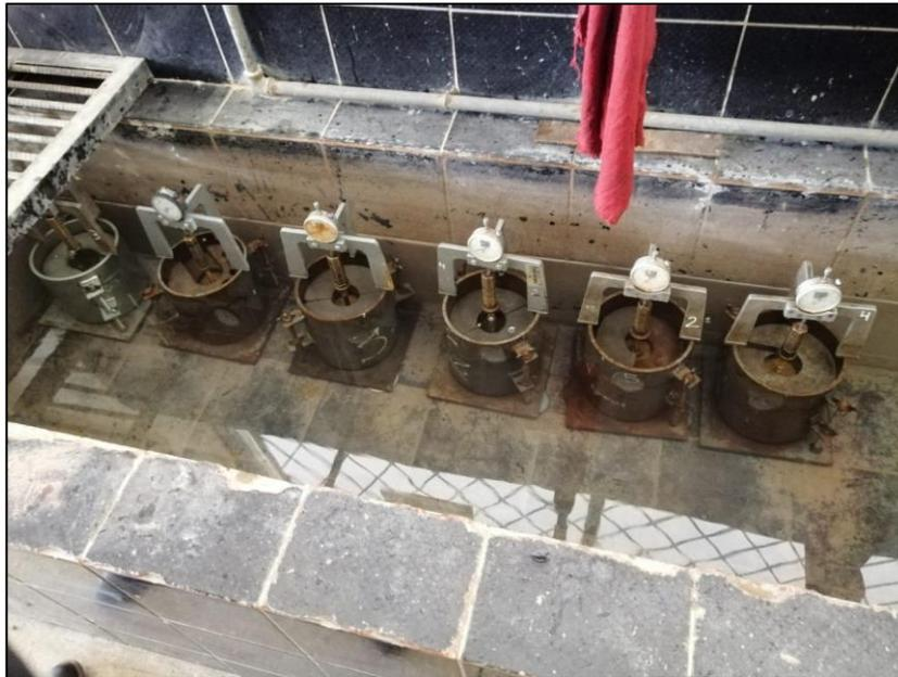
**Figura 32.** Ensayo de hinchamiento (3 por cada calicata)
