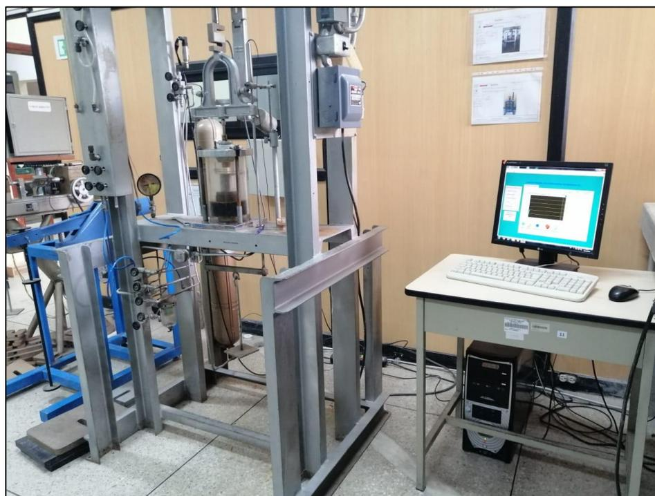
**Figura 39.** Ensayo Triaxial
