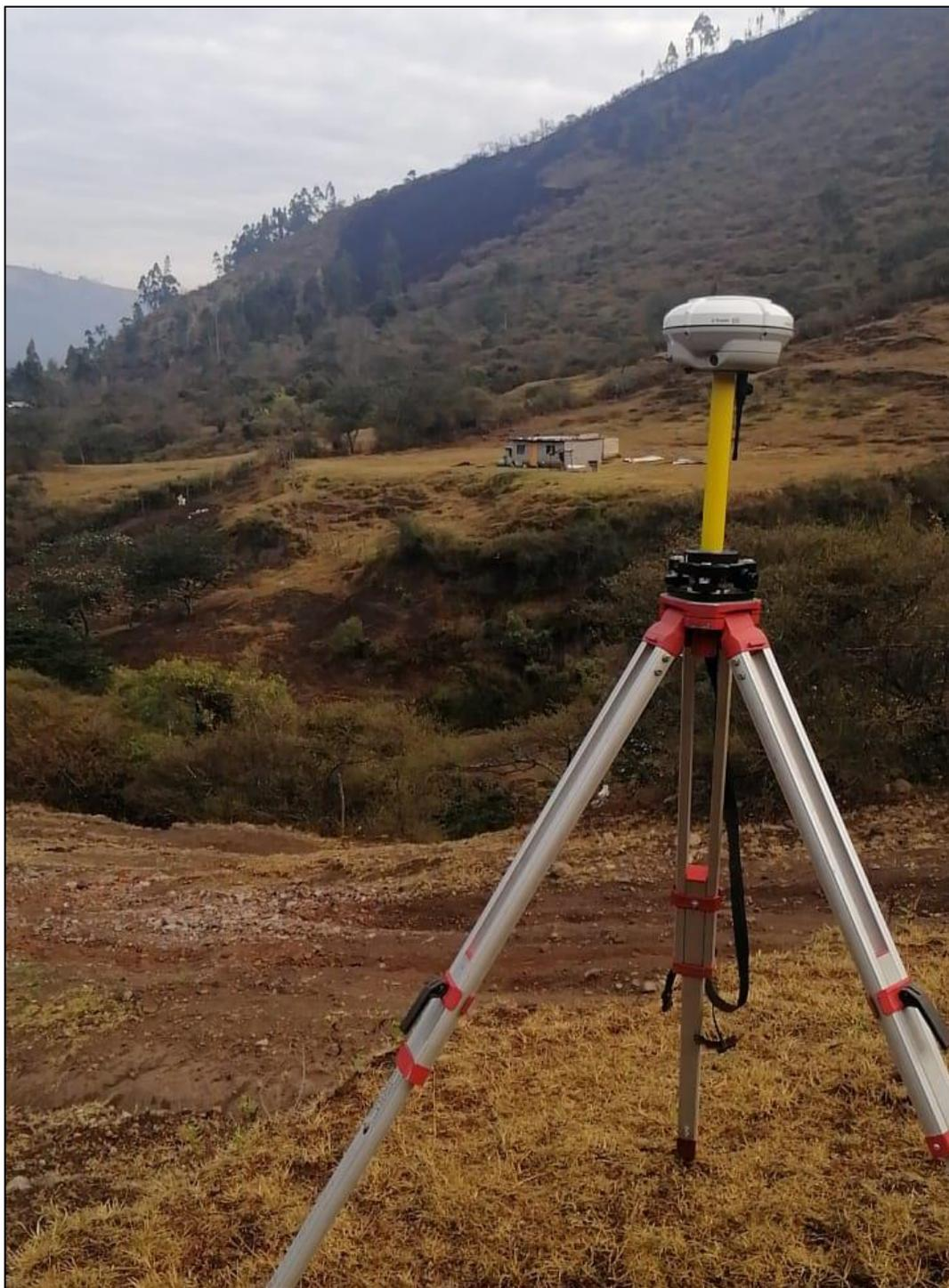
**Figura 6.** GPS de alta precisión
