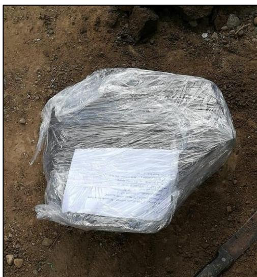
**Figura 15.** Muestra Inalterada
