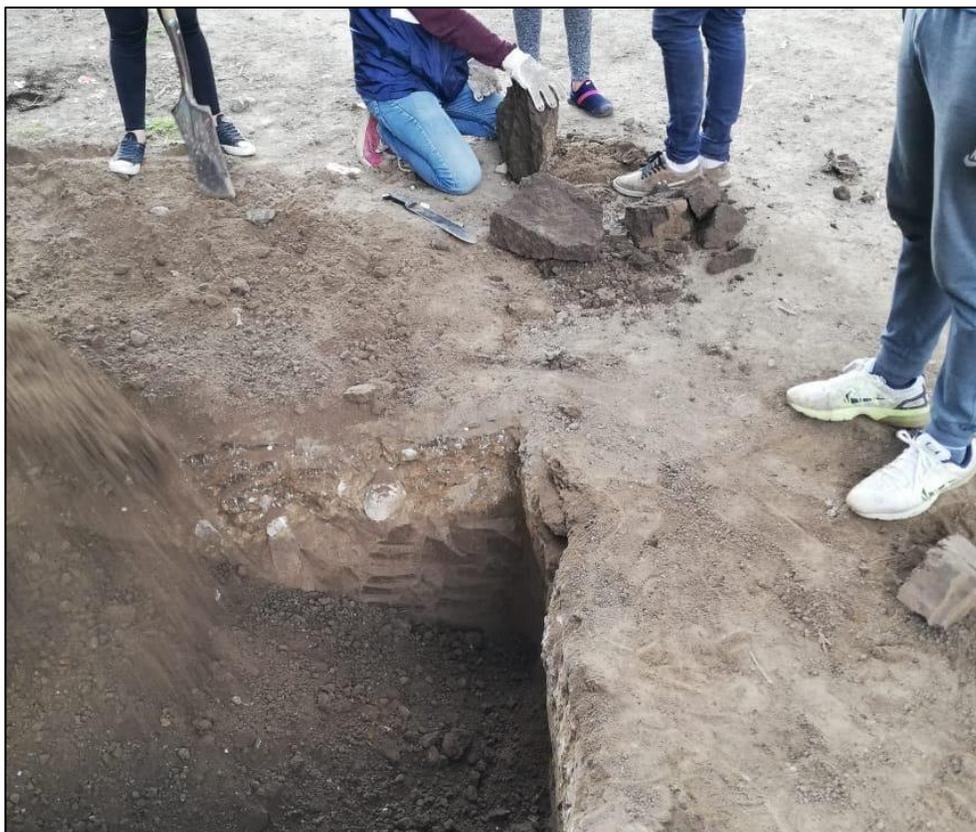
**Figura 18.** Toma de muestras inalteradas y cierre de calicata #2
