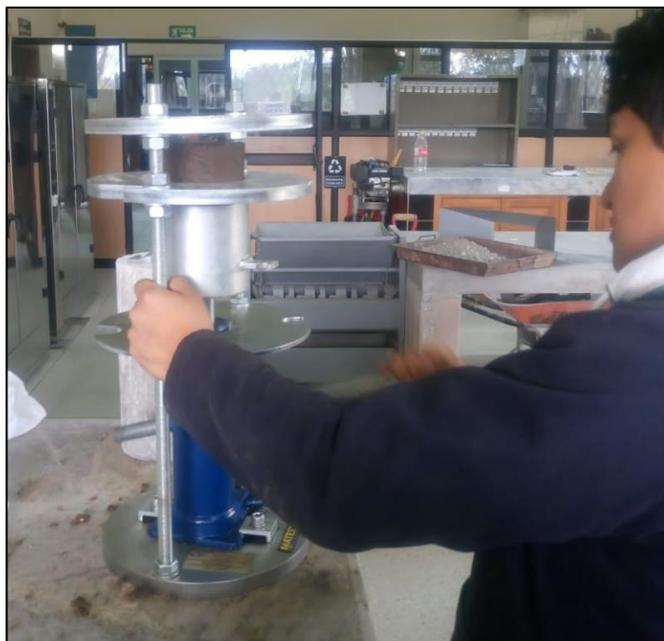
**Figura 28.** Gata Hidráulica para sacar las muestras de suelo compactadas
