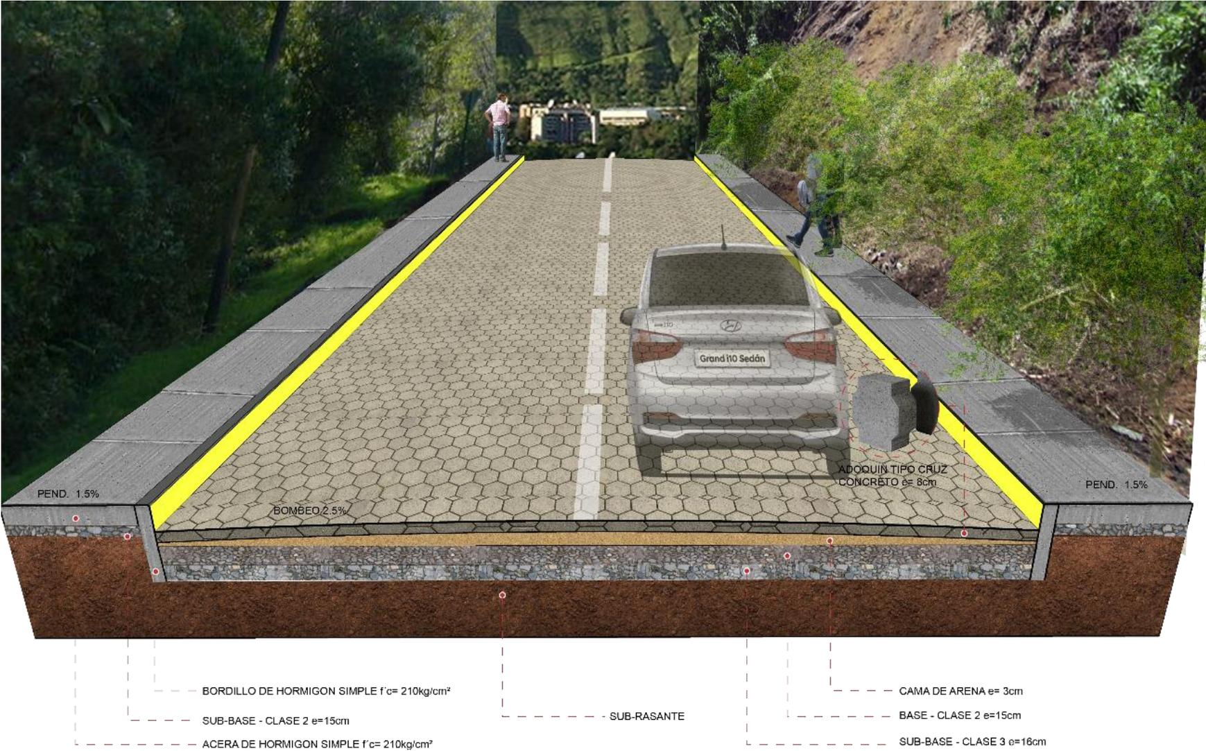
Figura 82. Sección Transversal
