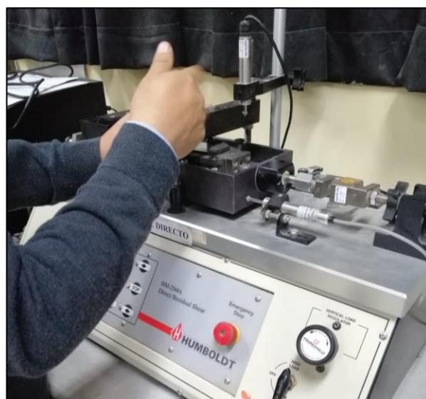
**Figura 41.** Ensayo de Corte Directo
