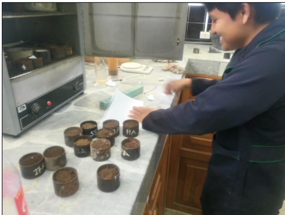
**Figura 20.** Ensayo de Contenido de Humedad
