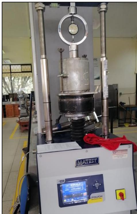
**Figura 33.** Ensayo de Penetración
