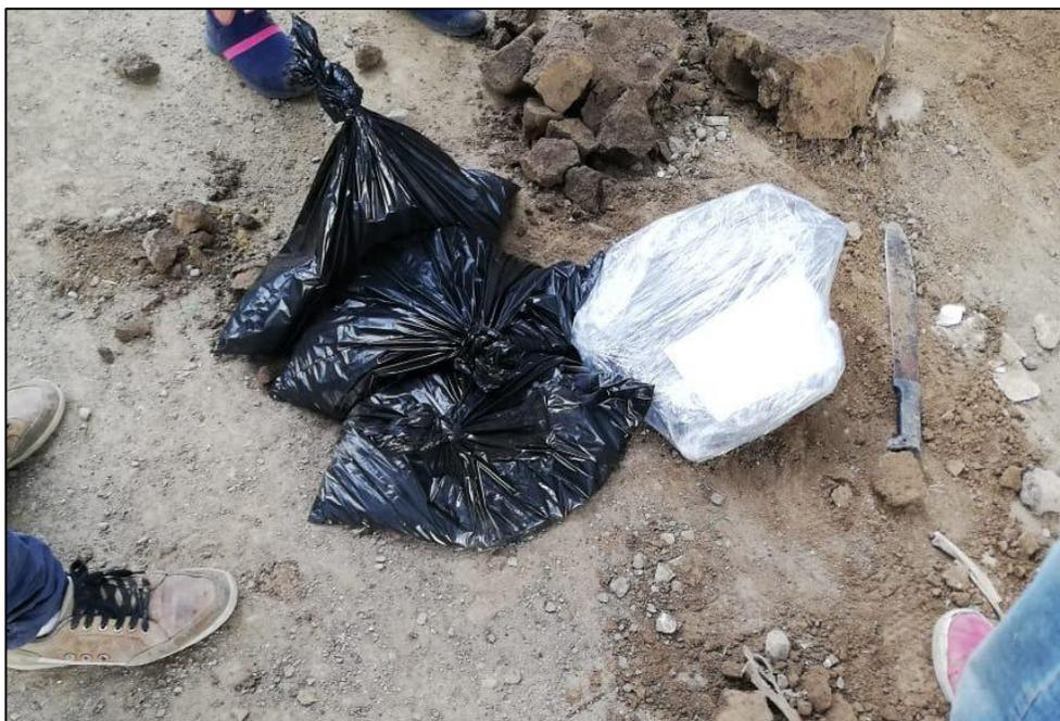
**Figura 19.** Muestras alteradas e inalteradas. Calicata #2
