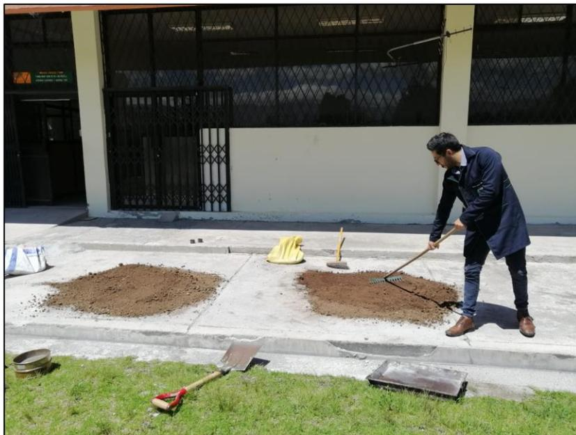
**Figura 30.** Preparación de las muestras a la humedad óptima
