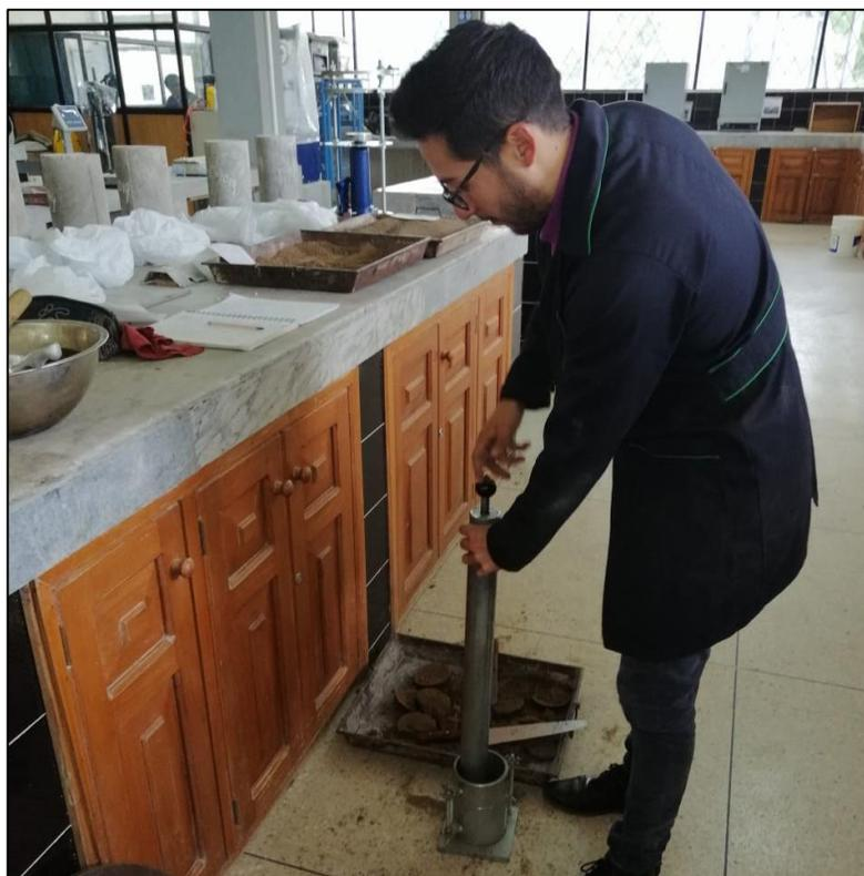
**Figura 27.** Ensayo de compactación
