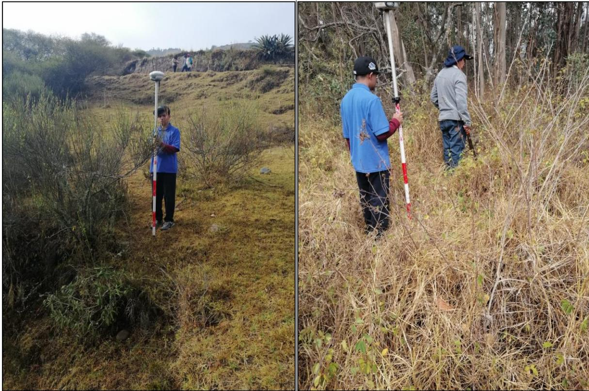
**Figura 7.** Levantamiento Topográfico con RTK dinámico
