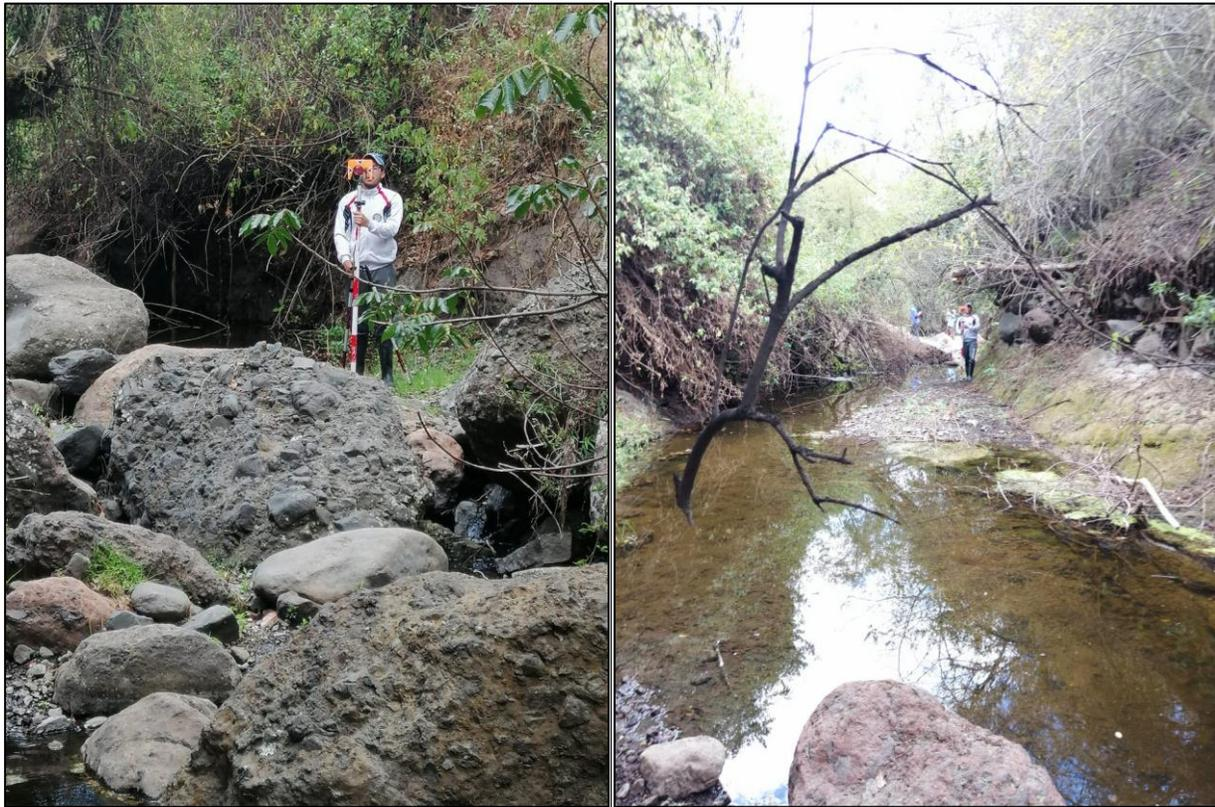
**Figura 10.** Levantamiento de la sección del río
