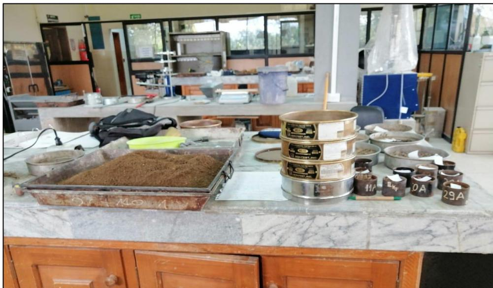
**Figura 22.** Ensayo de Granulometría
