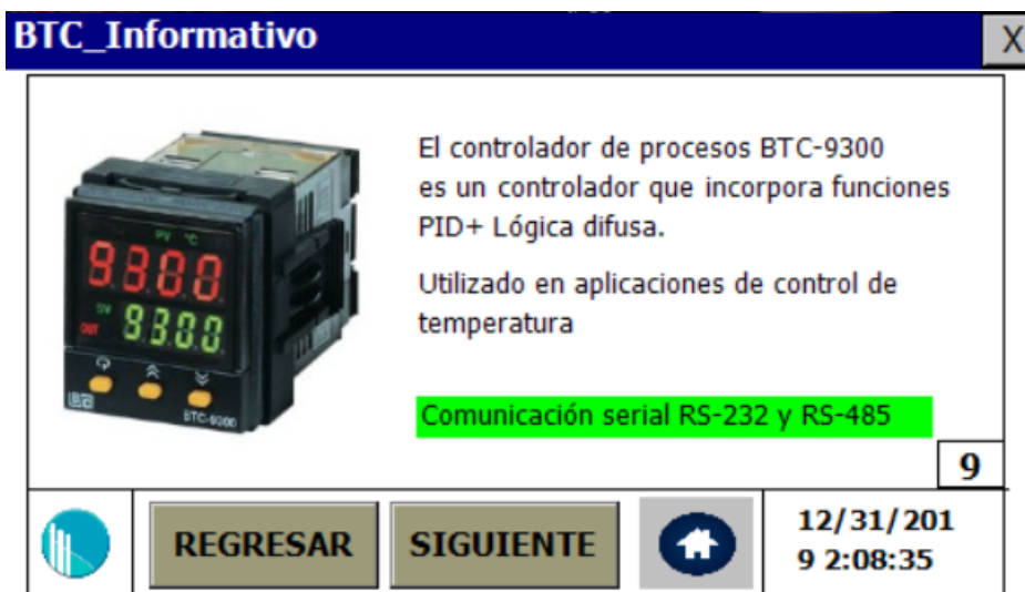
Figura 37. Pantalla informativa de controlador BTC 9300.
