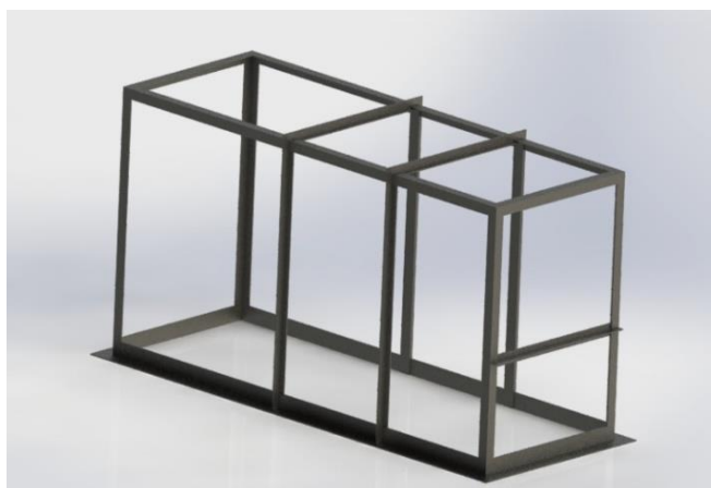
Figura 27. Estructura interna (alma) de la cámara
