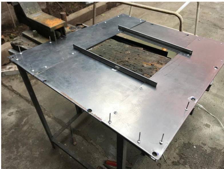
Figura 55. Remachado de tapa frontal
