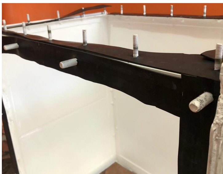
Figura 53. Sistema de sujeción tapas
