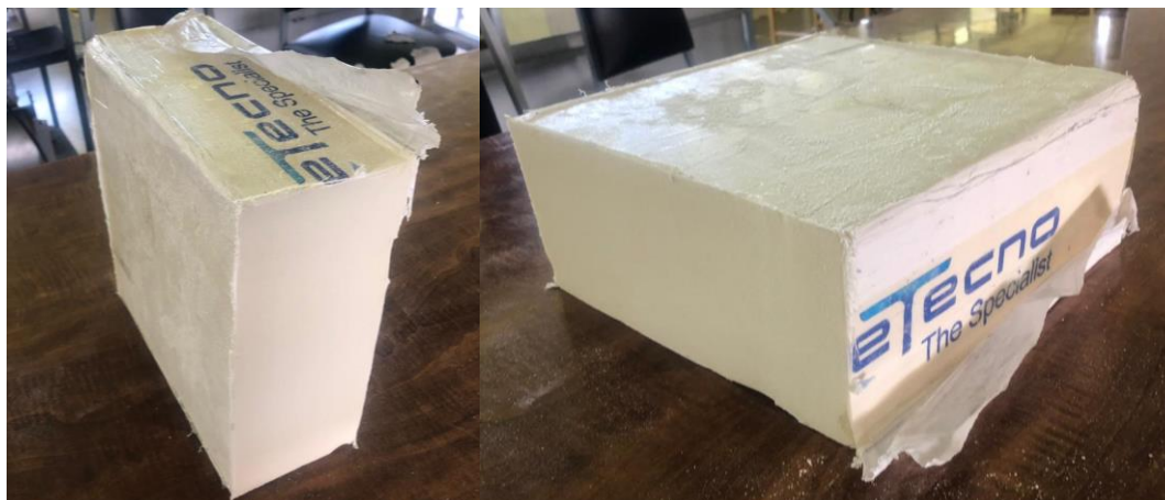
Figura 64. Probetas de Poliuretano Expandido MeTecno®
