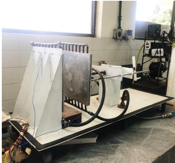
Figura 1. Banco de pruebas para la determinación de Conductividad térmica
