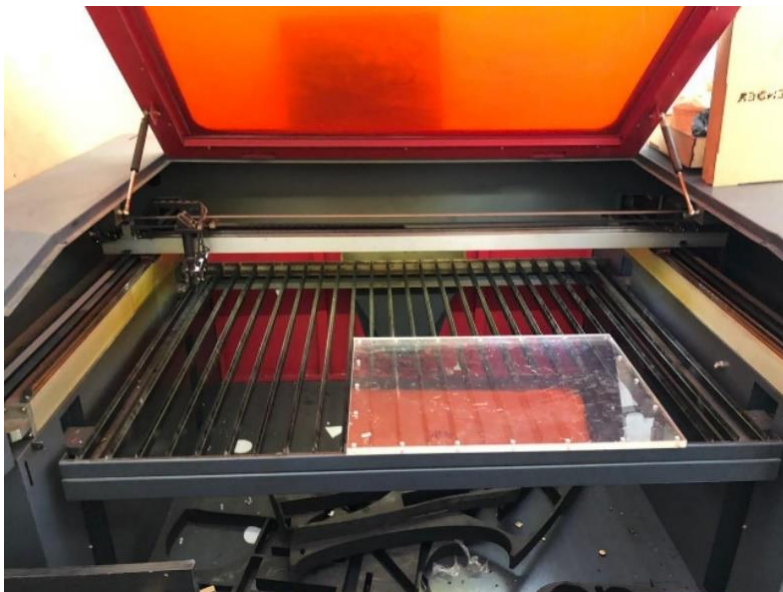
Figura 54. Corte láser de las tapas
