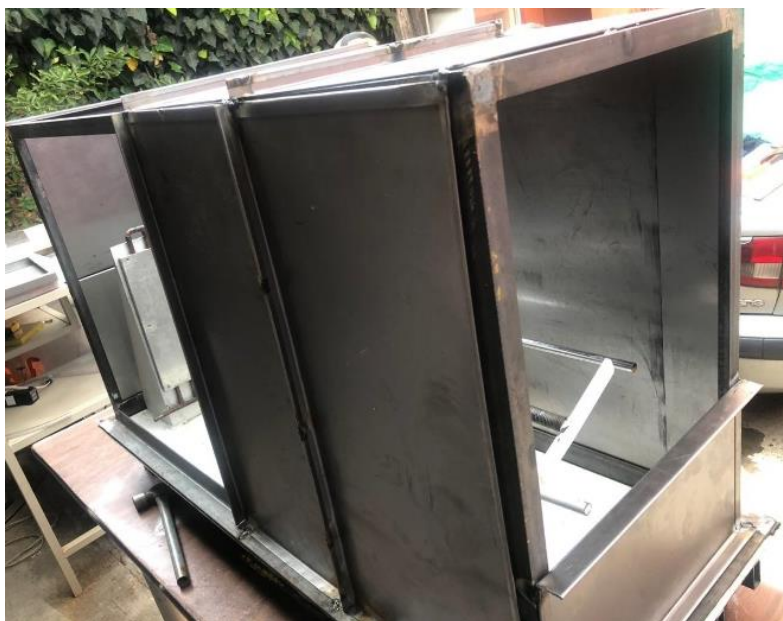
Figura 52. Tapas fijas de acero laminado de la cámara de vacío
