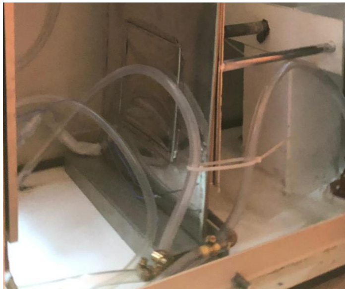
Figura 50. Disposición de la manguera plástica de 3/8 [in]
