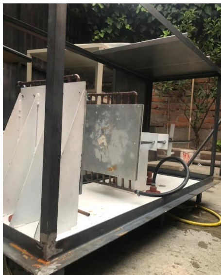
Figura 51. Empotramiento de la estructura interna de la cámara a la prensa
