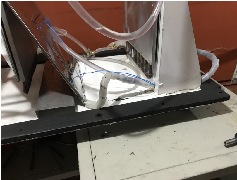
Figura 60. Aislamiento con empaque de la prensa y la cámara de vacío
