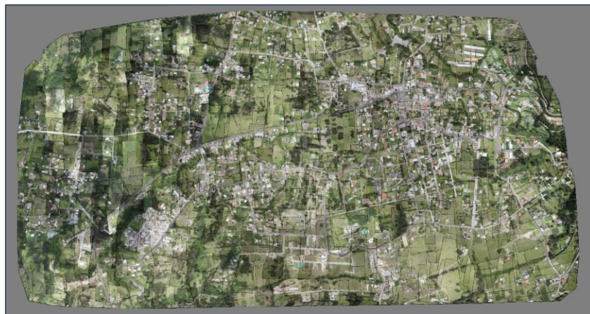
Figura 75. Visualización preliminar del ortomosaico – Photomod UAS
