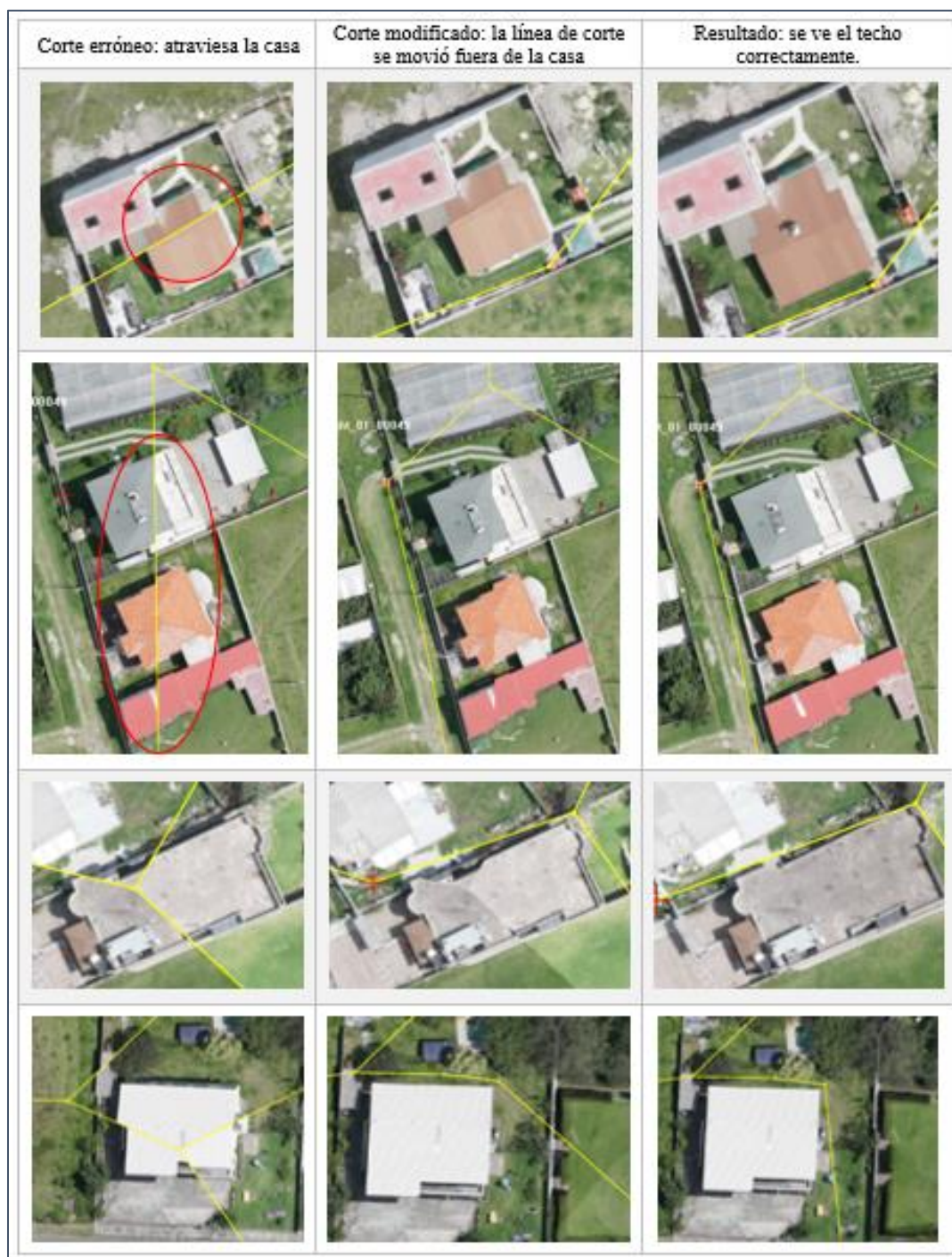
Figura 78. Visualización de las líneas de corte – Photomod UAS
