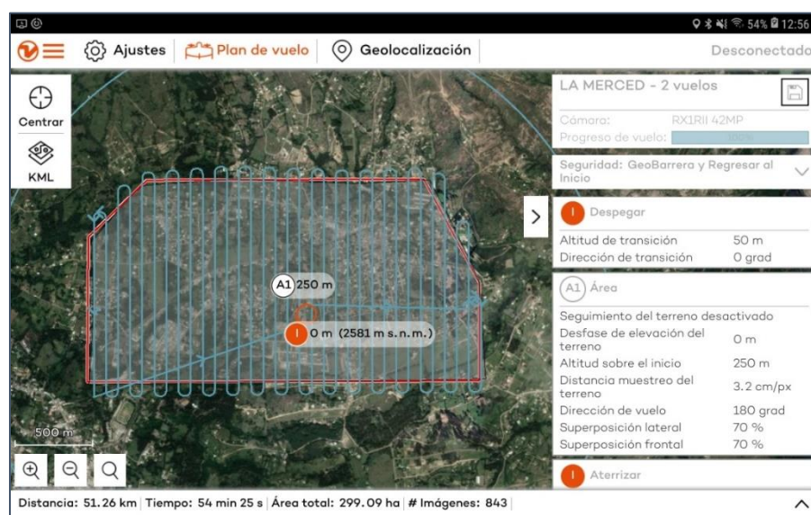
Figura 124. Plan de vuelo –WingtraPilot
