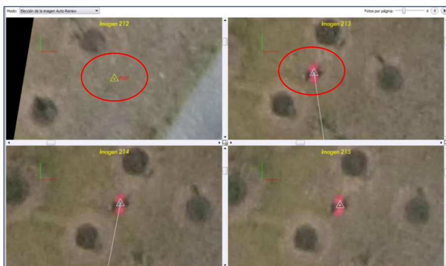
Figura 94. Pinchado de GCP – UASMaster
