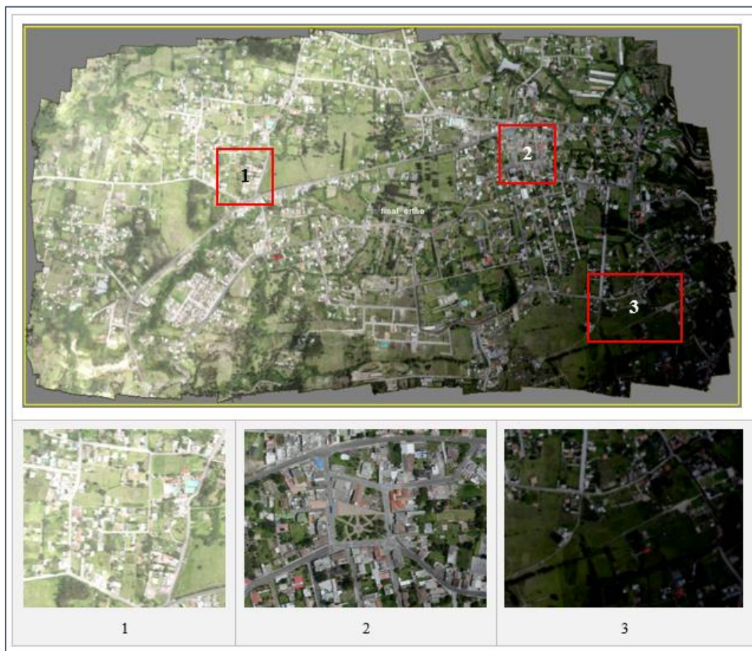
Figura 142. True Ortho con “Ajuste de brillo global” – Photomod UAS
