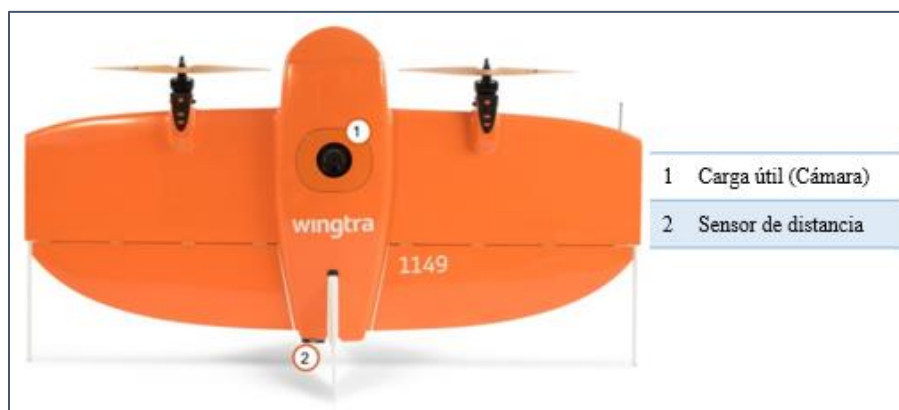
Figura 34. Partes del UAV WingtraOne (Vista inferior)
