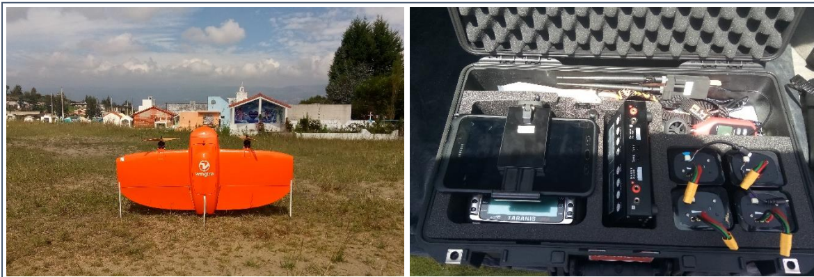
Figura 50. Preparación del equipo antes del vuelo a) UAV WingtraOne b) Partes y piezas
