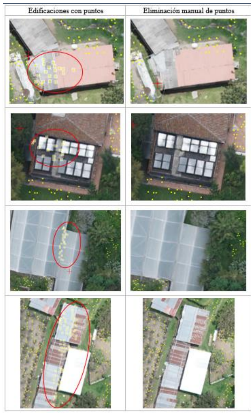
Figura 68. Filtrado de puntos en edificaciones – Photomod UAS
