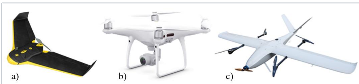
Figura 27. UAV: a) Ala fija, b) Multirrotor, c) VTOL
