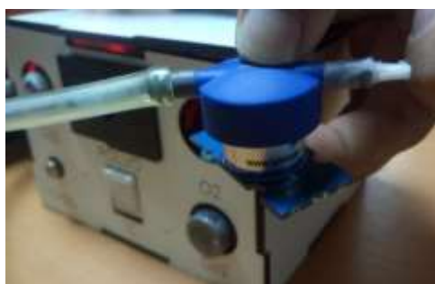
Figura 41. Colocación correcta de la capucha con el sensor.
