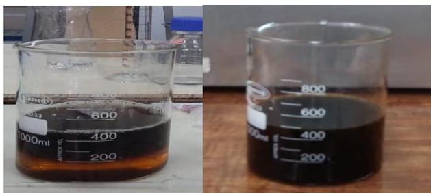
**Figura 15.** Formación y filtración de Np de hierro
