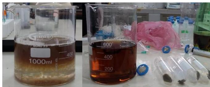
**Figura 16.** Formación y filtración de Np de Manganeso
