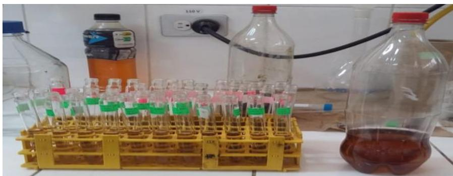
*Figura 20.* Nanopartículas de Mn aplicadas en las soluciones de As
