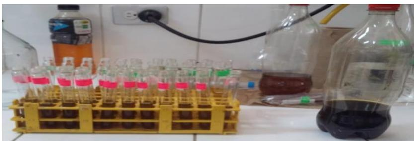
**Figura 19.** Nanopartículas de Fe aplicadas en las soluciones de As
