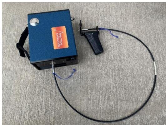
*Figura 15.* Espectroradiómetro
