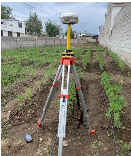
*Figura 19.* Posicionamiento de los puntos de control
