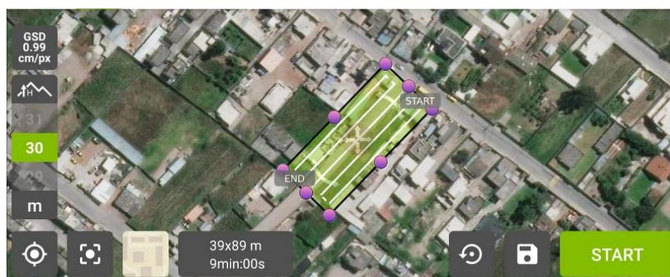
**Figura 18.** Área y parámetros de vuelo en la aplicación Pix4D
