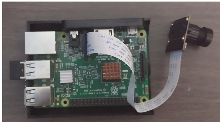
Figura 13. Conexión de RPI3 y cámara NoIR
