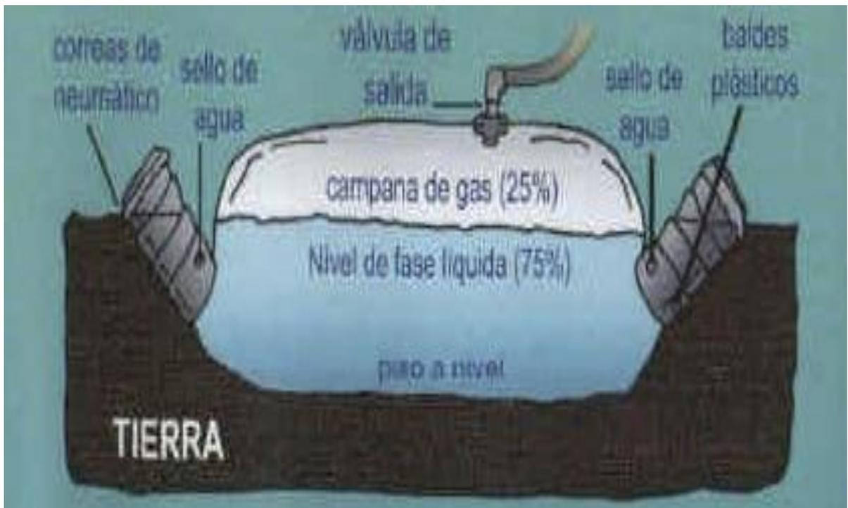
**Figura 3.14 Distribución de volumen en el digestor (vista lateral)**
