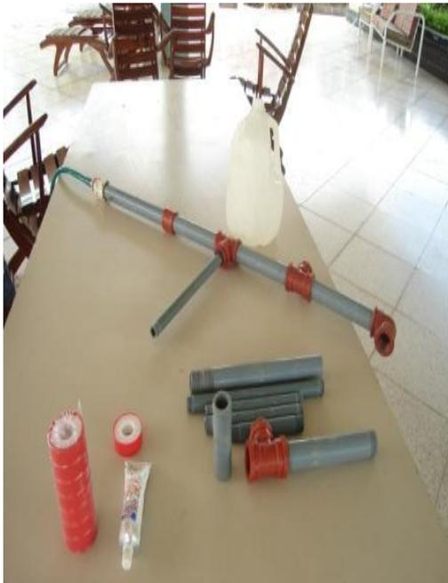
**Fotografía 4.35** Tubería acoplada de la línea de salida de gas.
