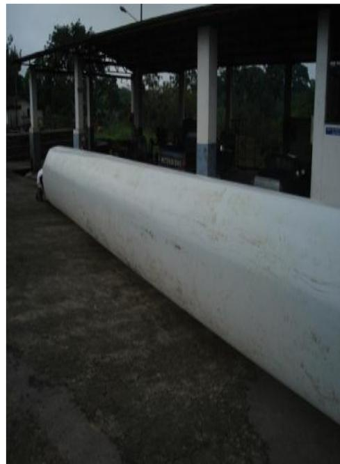
**Fotografía 4.31 Inflado parcial y total de la funda de polietileno para comprobar que no existan fugas**
