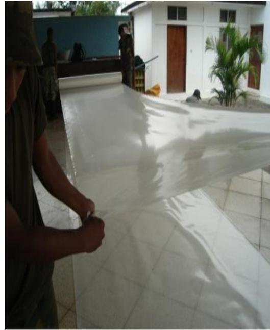
**Fotografía 4.19 Corte de dos longitudes iguales del rollo de polietileno.**
