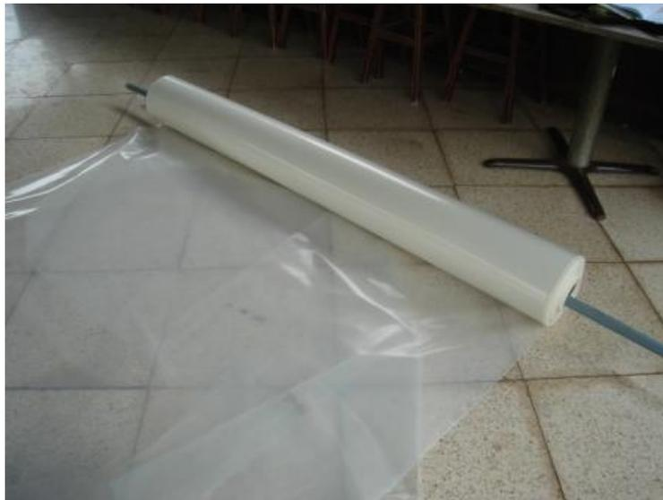
**Fotografía 4.17 Colocación de una varilla a través del centro del rollo**
