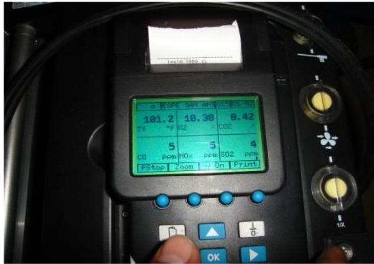
**FOTOGRAFÍA 5.3 Datos del analizador de gas de la empresa WARTSILA ECUADOR**
