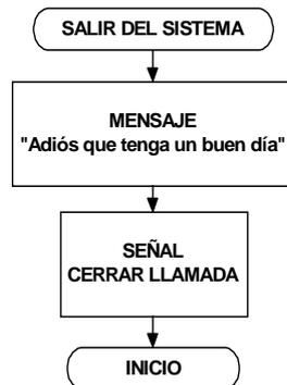
Figura. 4.18. Diagrama de Flujo (Salir del Sistema)
