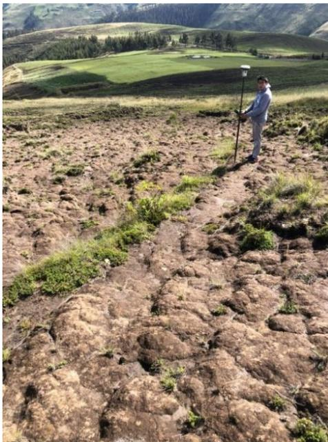
Nota: La figura muestra el trabajo de campo en cuanto al posicionamiento RTK para el respectivo replanteo de puntos, materializando cada punto con estacas.
