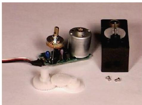
Fig. 2.11: Composición interna de un servomotor
