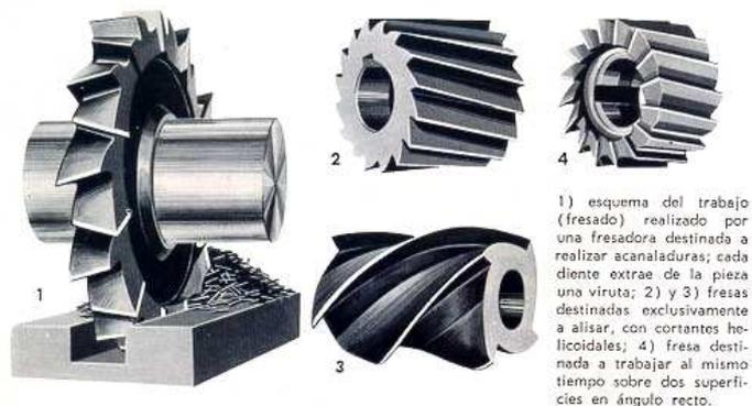
Fig. 1.6: Herramientas de corte periférico y frontal<sup>6</sup>
