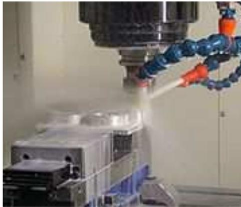
Fig. 1.12: Fresado de aluminio utilizando taladrina
