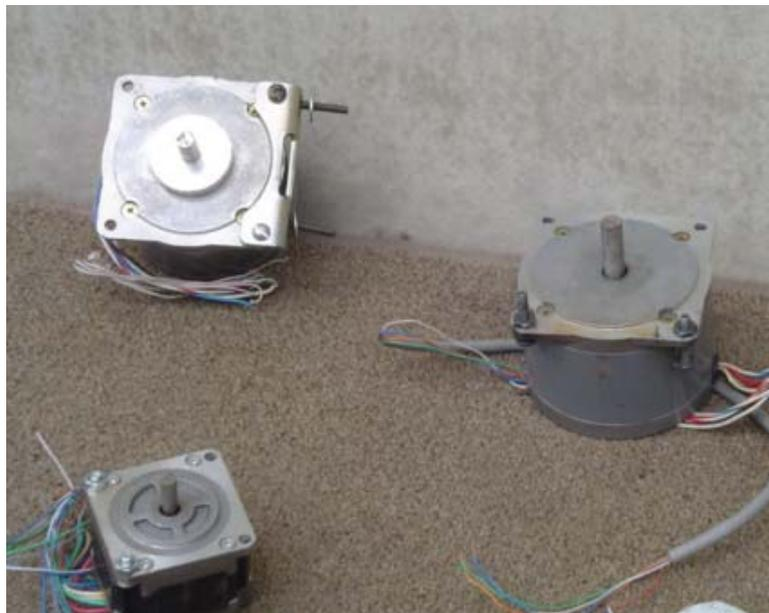
**Figura. 5.15. Motores de los ejes X,Y,Z**
