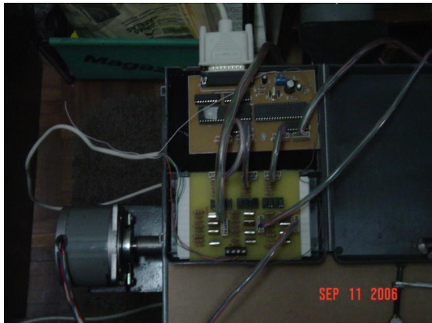
Figura. 6.5. Circuito de Potencia y motores
