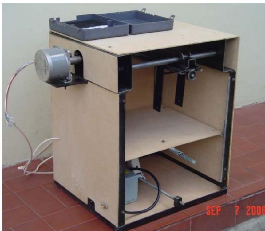
Figura. 5.27. Impresora para modelos 3D en cera (2)
