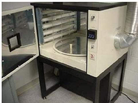
**Figura. 1.5. Horno ultravioleta**
