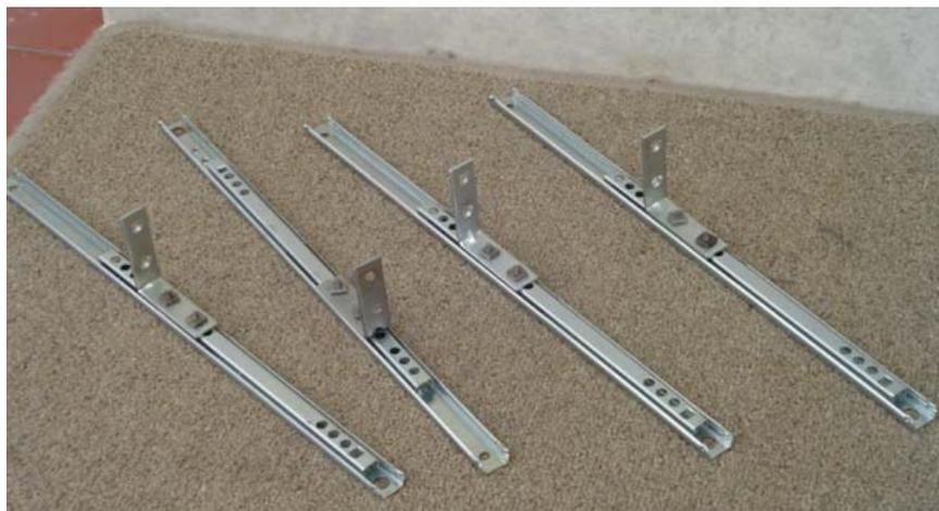
**Figura. 5.17. Rieles para el eje Z**
