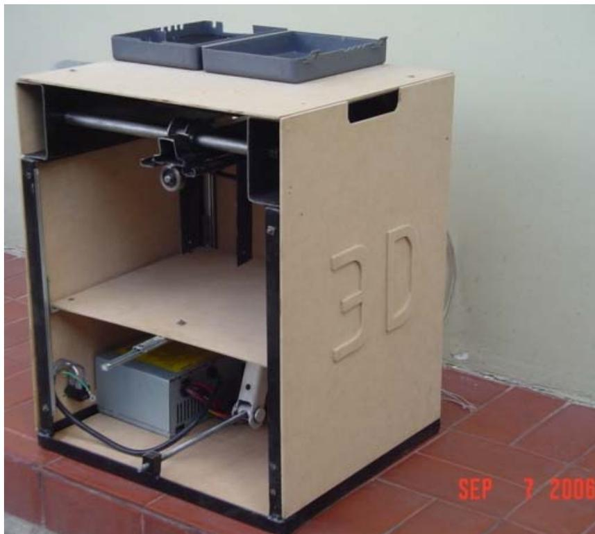
Figura. 5.26. Impresora para modelos 3D en cera (1)
