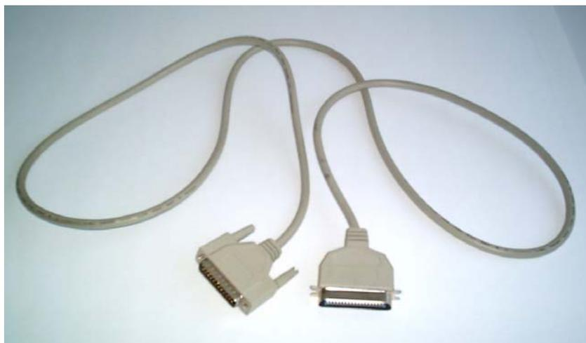
**Figura. 3.5. Cable conector para puerto paralelo**
