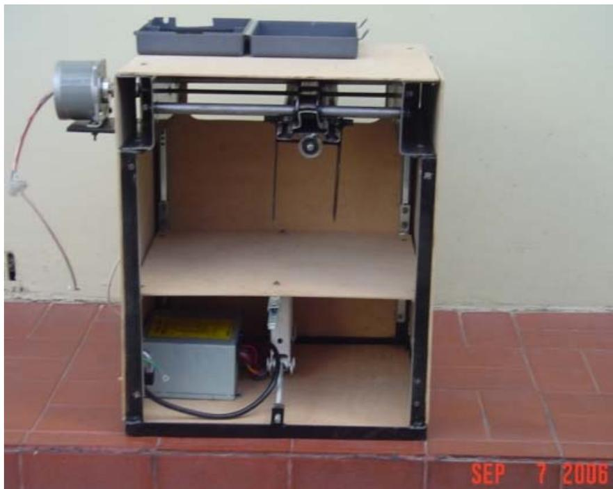
Figura. 5.28. Impresora para modelos 3D en cera (3)
