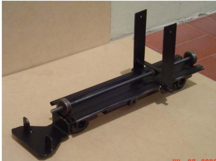
Figura. 5.13. Estructura del Eje Y
