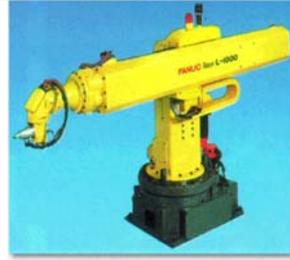
**Figura. 1.30. Robot esférico (R)**
