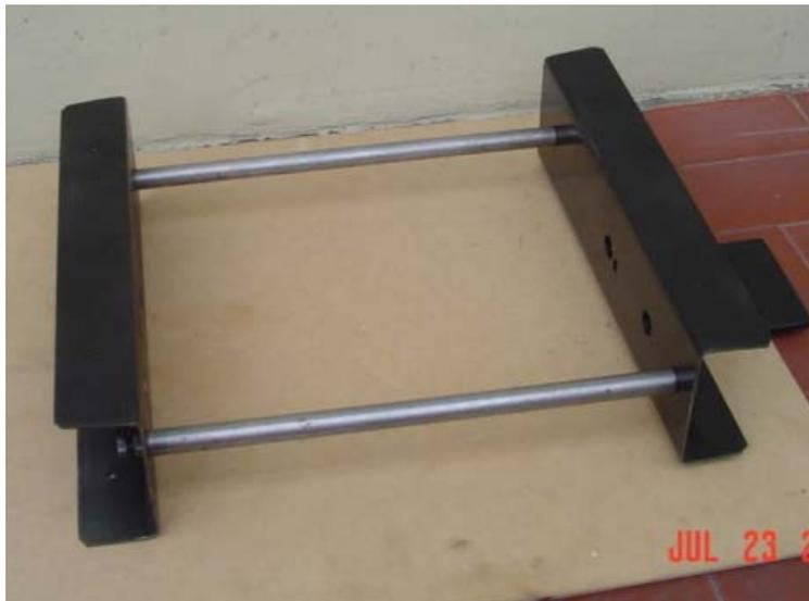
**Figura. 5.4. Ejes de Transmisión y Canaleta tipo C**
