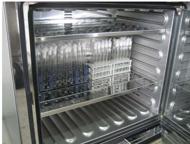
Tubos de ensayo en incubador estático durante los ensayos de comprobación de la inhibición de la actividad bacteriana.
