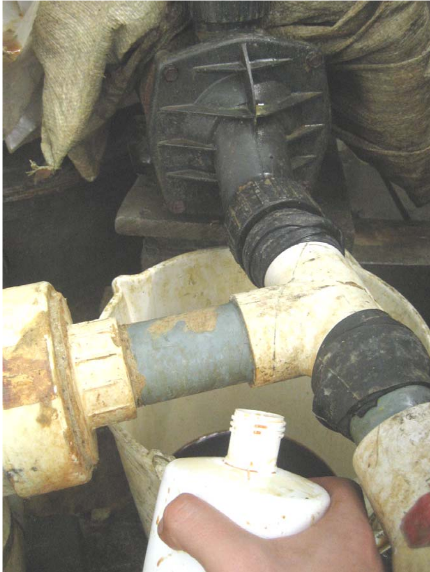
Toma de muestra del sitio de descarga de la torre de biolixiviación.
