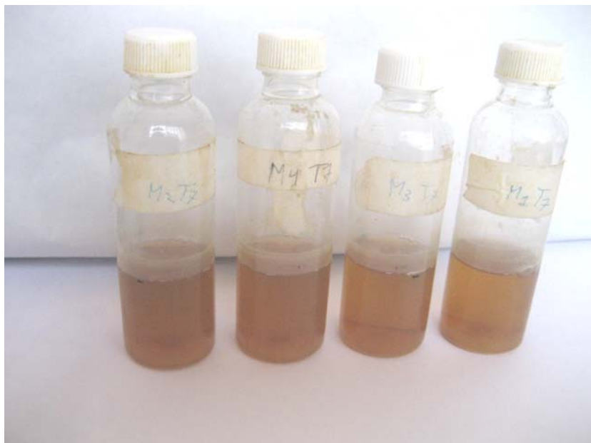
Muestras de agua residual luego de ser sometidas a tratamientos con texapon.
