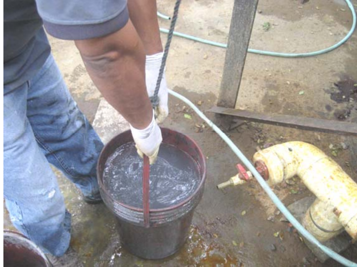
Adición de medio 9K a la torre de biolixiviación.
