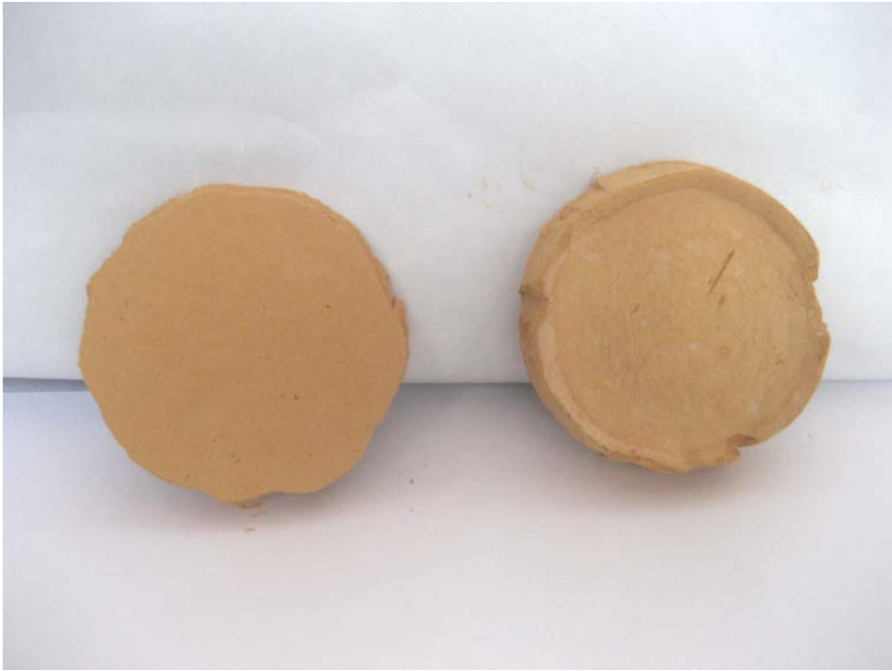
Precipitados provenientes del tratamiento BIOX™ convencional de las muestras de agua residual de la torre de biolixiviación.
