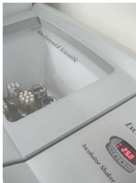
Muestras de agua residual dentro de agitador orbital durante los ensayos de inhibición de la actividad bacteriana.
