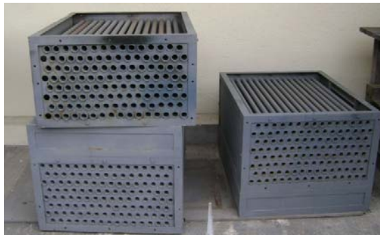
Figura 3.7 Intercambiadores de calor
