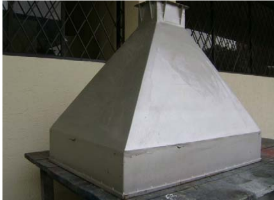
Figura 3.1 Tolva de carga
