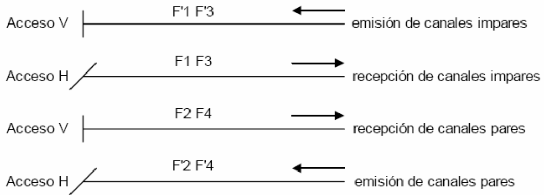
Figura. 3.13. Uso de dos antenas
