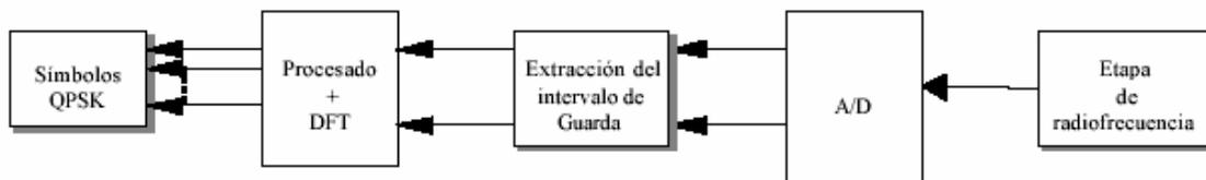
Figura 2.7 Esquema del Modulador / Demodulador OFDM
