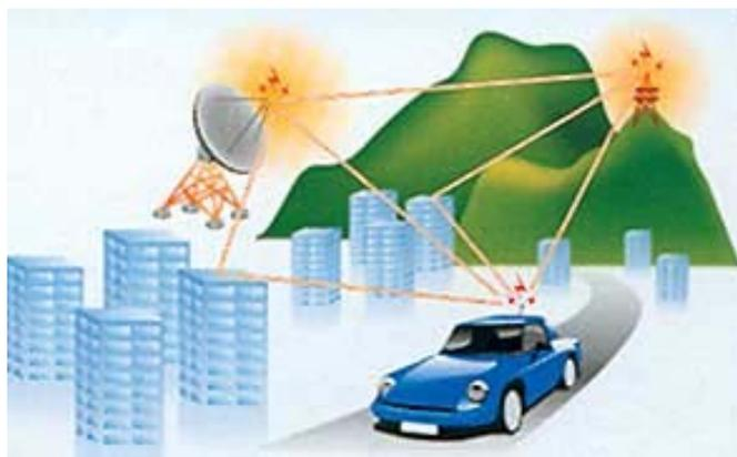
Figura 3.1 Señal Multitrayecto
