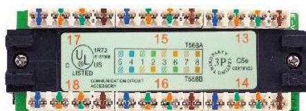
Figura. 5.4. Par Protocolo 568-A ó 568-B.
