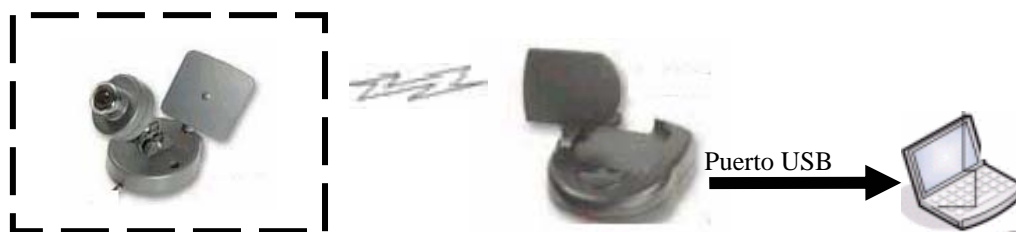
Figura. 3.16. Comunicación entre la cámara y su capturadora de video
