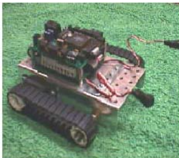
Figura. 2.5. Tracción Mediante Orugas
