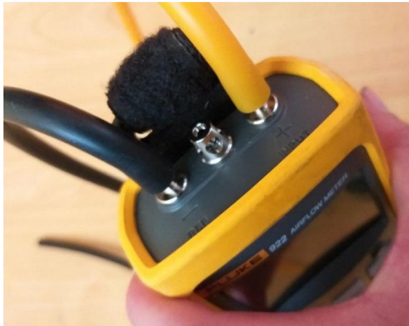
Figura 61. Conexión de mangueras para la medición de velocidad de aire.
