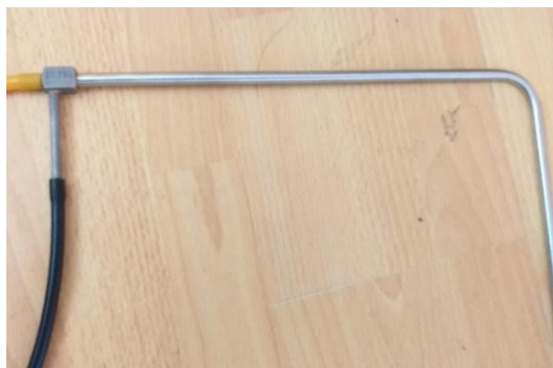
Figura 62. Conexión de las mangueras al tubo de pitot
