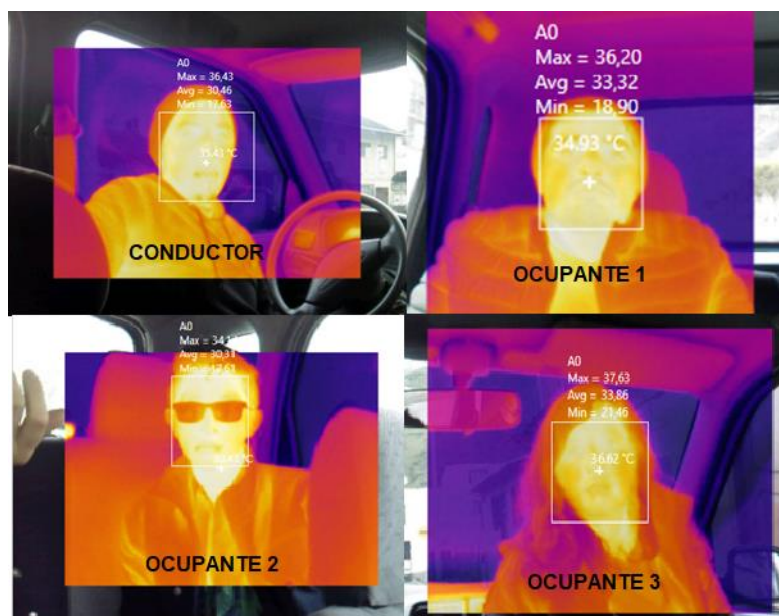
Figura 132. Termografía Sierra condiciones normales de A/C.
