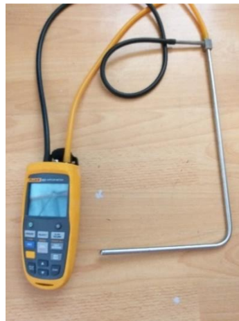
Figura 64. Conexión del caudalímetro
