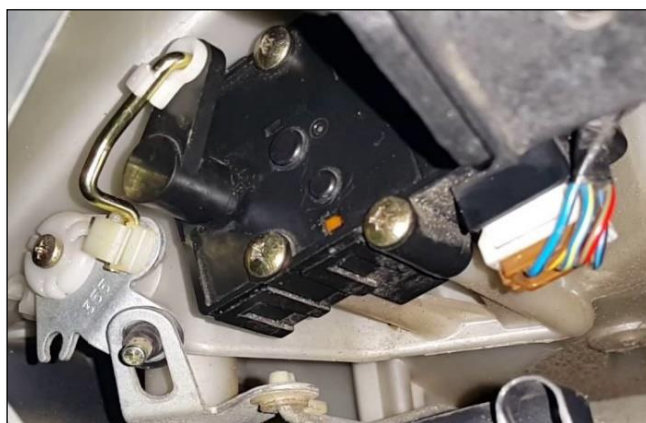
Figura 13. Servomotor del sistema de A/C
