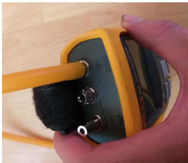
Figura 59. Conexión para la medición de presión de aire.
