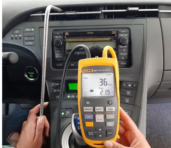
Figura 66. Medición de volumen de aire.
