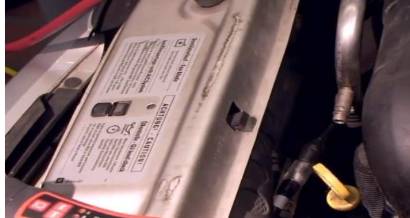
Figura 110. Detención de fugas del sistema de A/C usando gas fomier.
