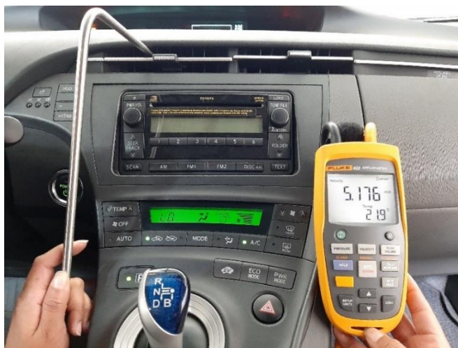
Figura 63. Medición de velocidad de aire.
