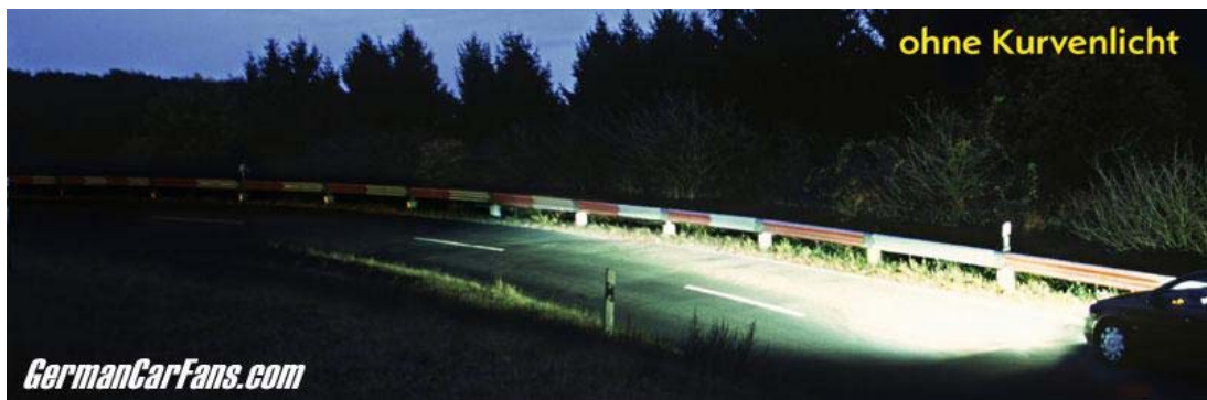
Figura. 2.7. Sistema SIN compensación en una Curva. [4]
