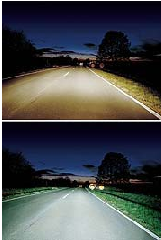
Figura. 3.5. Comparativa entre la Luz Blanca de los Faros de Xenón y la Luz Amarilla de los faros Halógenos comunes
