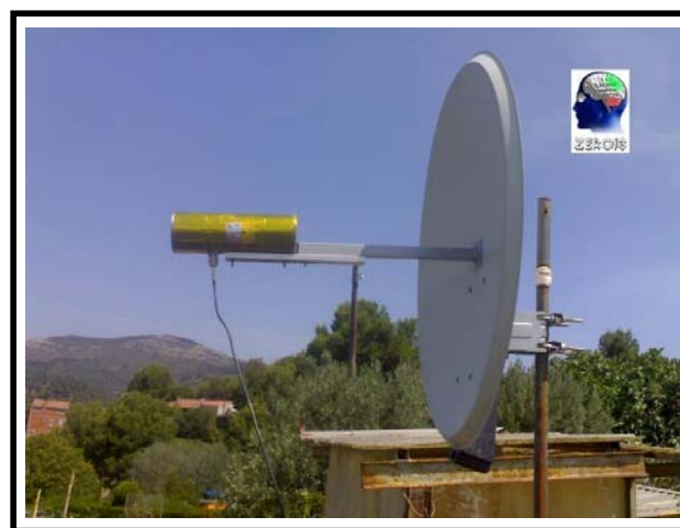
FIG. 2.10 ANTENA DE REFLECTOR O PARABÓLICA
