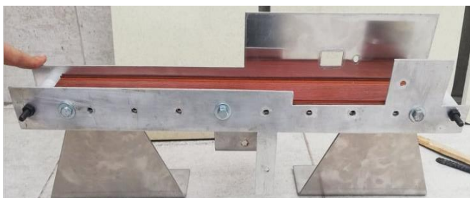
Construcción de la Banda Transportadora
